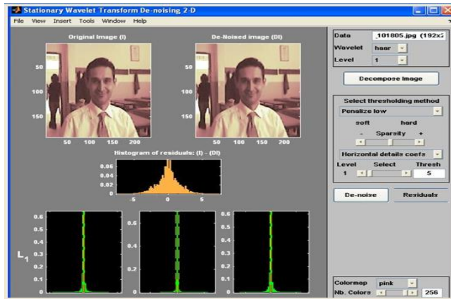
Şekil 4.6: Matlab ile Dalgacık Dönüşümü(Gürültüden Arındırma)
