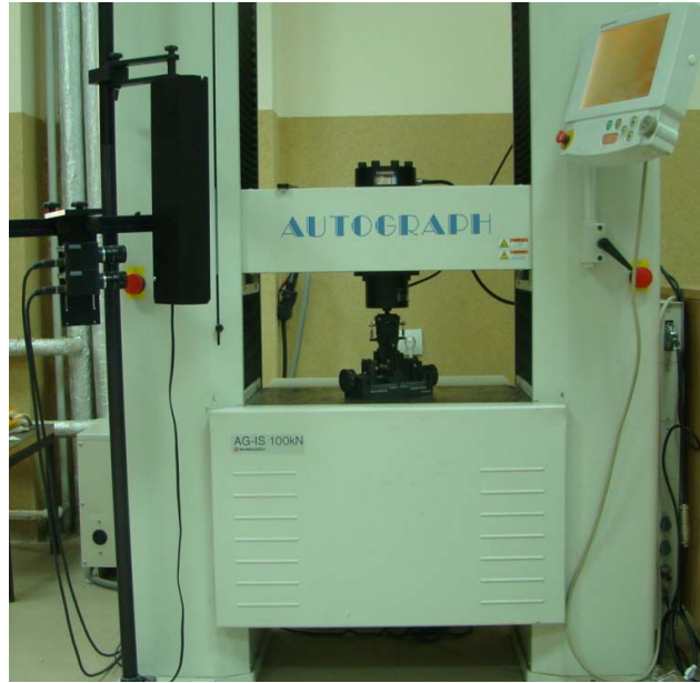
Şekil 3. 2. Biyomekanik testler için kullanılan germe-kopartma cihazı (Shimadzu Autograph AG-G series, Shimadzu Co, Kyoto, Japonya).
