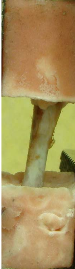
Şekil 3.3. Akrilik içene gömülerek çekme deneyine hazırlanmış bir femur
