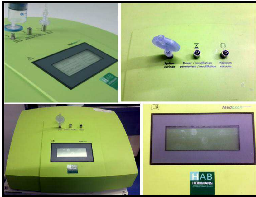
Şekil 3.2.2. Enjektörün ozon jeneratöründe yerleştirildiği yer ve ozon konsantrasyon ( \mu\text{g}/\text{ml} ) ve hacminin (ml) ayarlandığı kısım.
