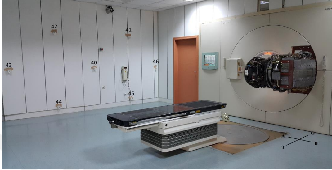
Şekil 4.12. Lineer hızlandırıcı odasındaki fotonötron akı tayini için içerisinde indiyum ve kadmiyum yaprakları bulunan bardakların konumu (Deney düzeneđi IV, A yönü)
