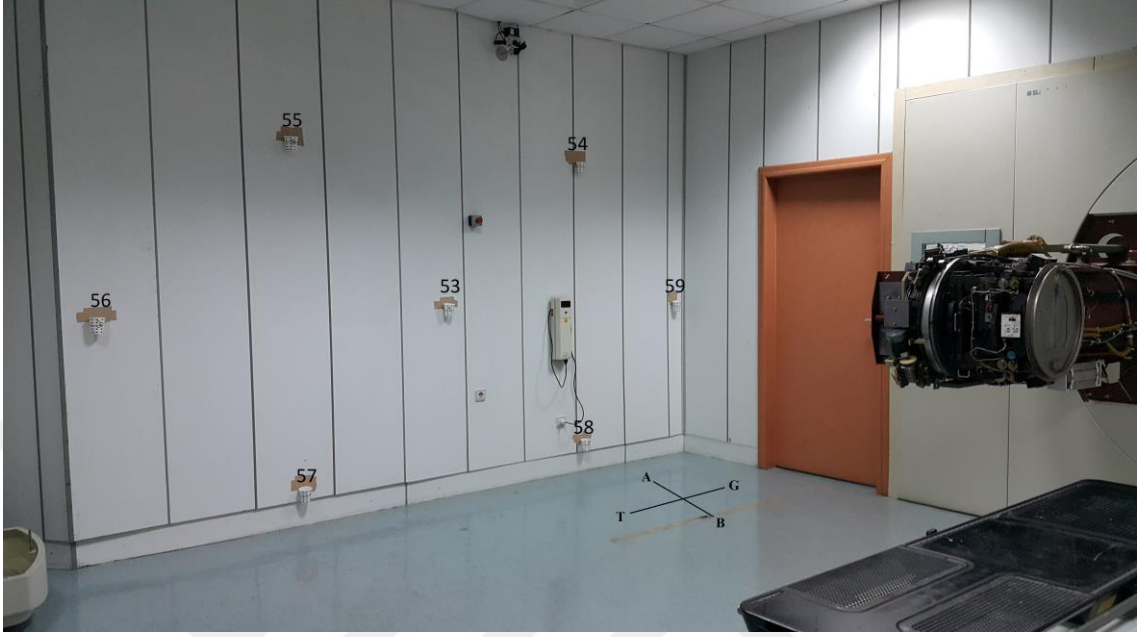
Şekil 4.18. Linear hızlandırıcı odasındaki fotonötron akı tayini için içerisinde indiyum ve kadmiyum yaprakları bulunan bardakların konumu (Deney düzeneđi V, A yönü)
