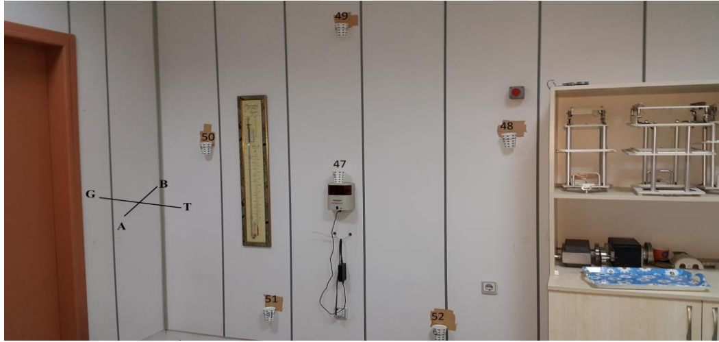
Şekil 4.13. Lineer hızlandırıcı odasındaki fotonötron akı tayini için içerisinde indiyum ve kadmiyum yaprakları bulunan bardakların konumu (Deney düzeneđi IV, B yönü)
