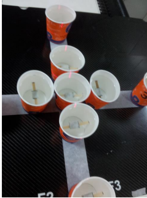
Şekil 3.19. ^{115}\text{In} ve ^{113}\text{Cd} yapraklarıyla oluşturulan deney düzeneği
