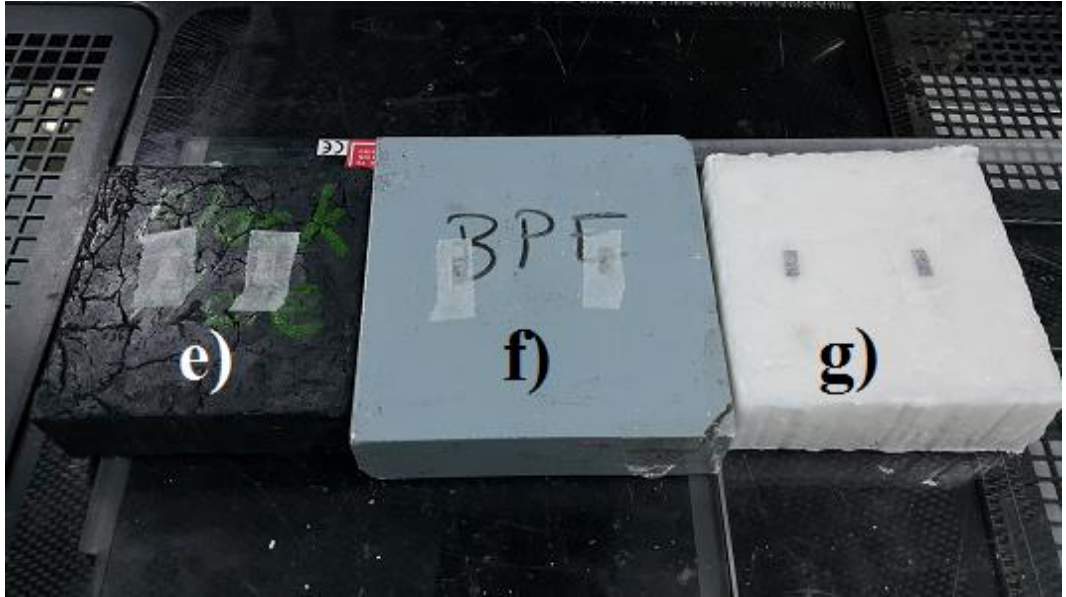
Şekil 4.36. Zırlama malzemeleri, e) Boron Parafin f) %5 BPE g) Parafin
