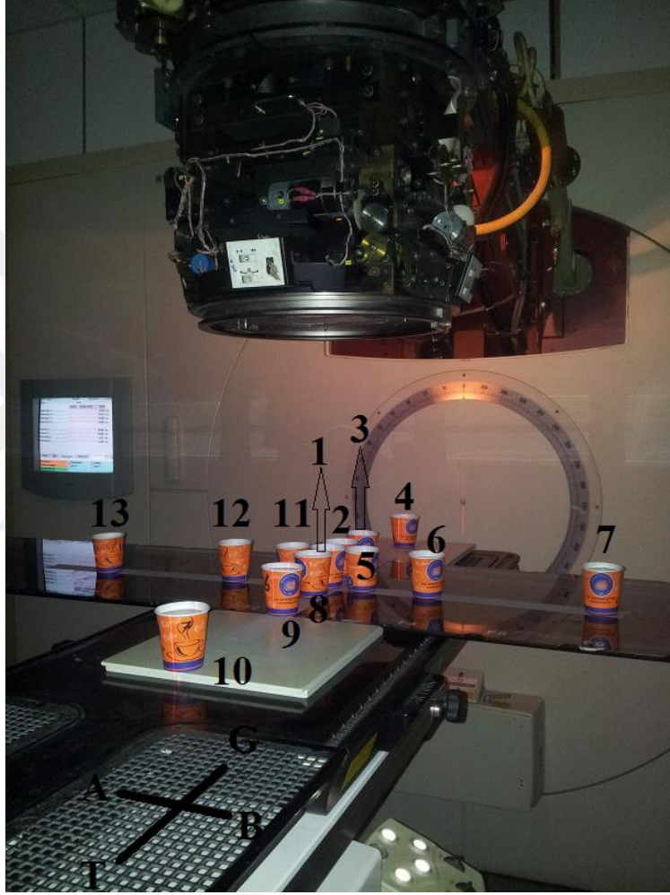
Şekil 4.1. Linear hızlandırıcı odasındaki fotonötron akı tayini için içerisinde indiyum ve kadmiyum yaprakları bulunan bardakların konumu (Deney düzenegi I)
