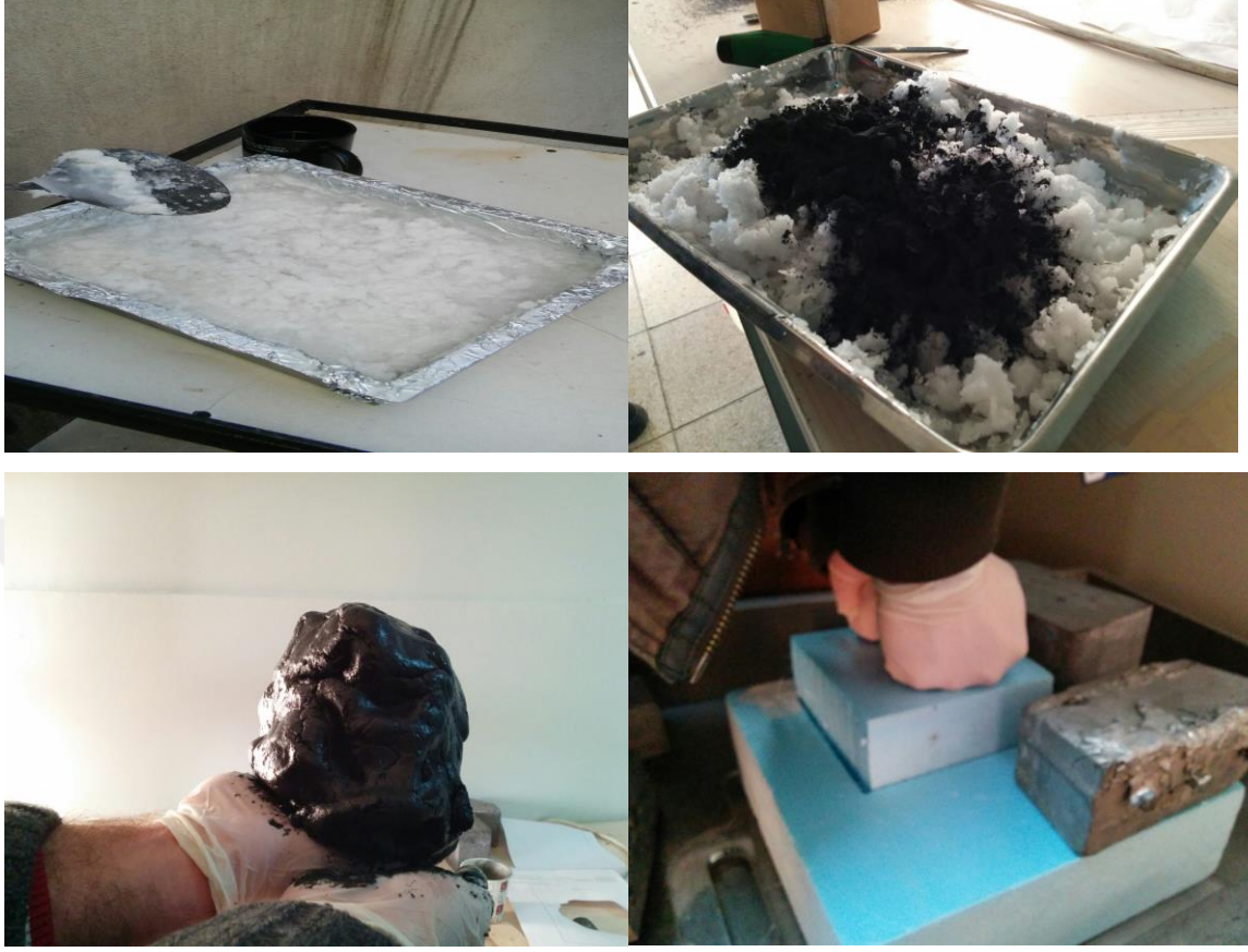
Şekil 3.9. B 4 C katkılı parafinin yapım aşamaları
