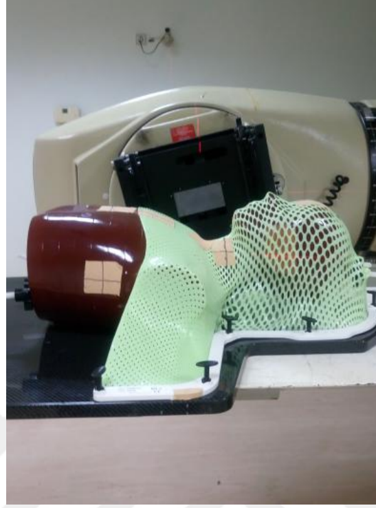
Şekil 3.25. Co-60 teleterapi cihazında rando fantom ışınması (A.Ü)
