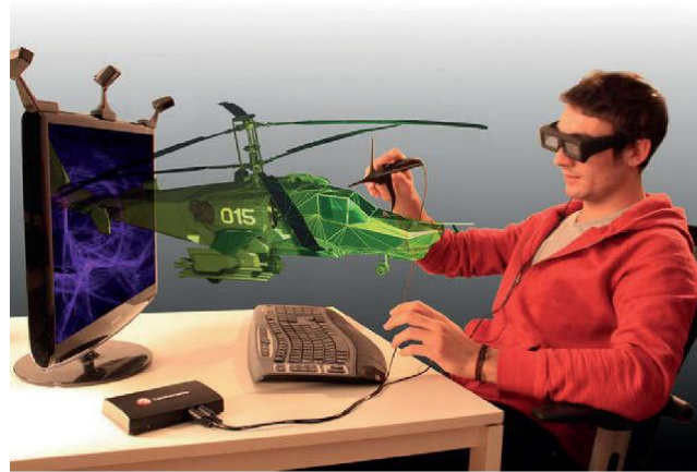
Şekil 13 : Kullanıcıyı Çevrelemeyen Masaüstü Sistemlere Örnek Olan Tekli Monitör ve 3D Gözlüğü İle Sanal Ortama Dalma Hissi.
