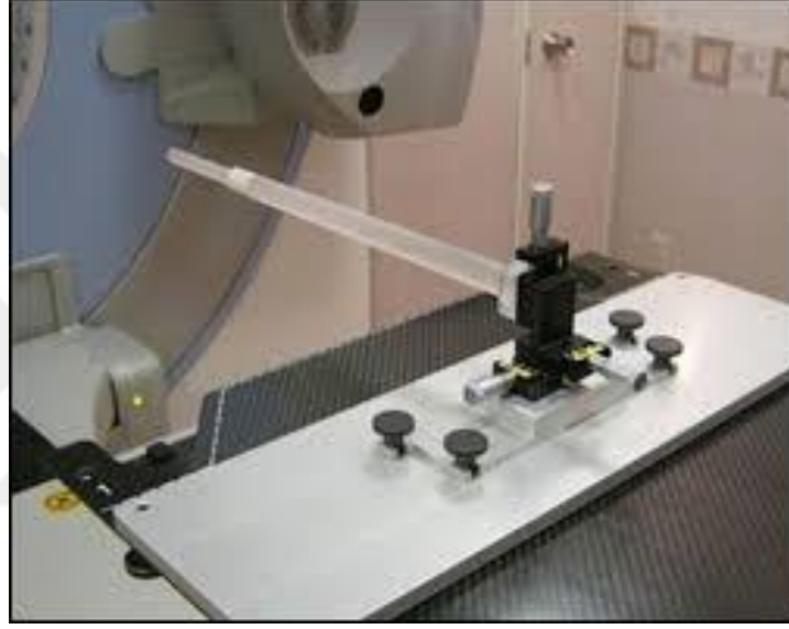
Şekil 2.31. Ball-bearing kalibrasyon fantomunun Elekta synergy XVI ve tedavi cihazı eşmerkezleşme kalibrasyonu temsili resmi
