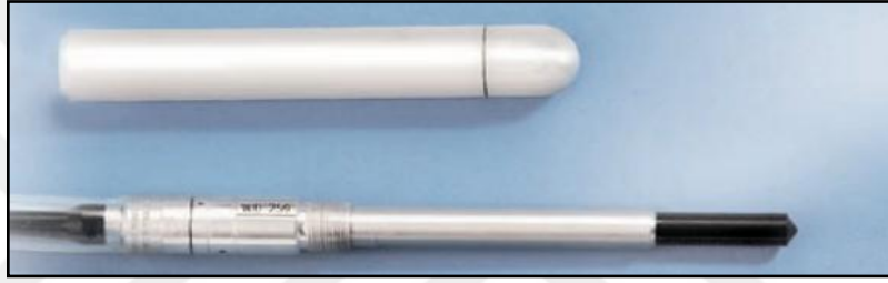
Şekil 3.4. IBA-Wellhöfer farmer tipi FC65P iyon odası
