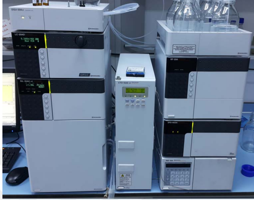
Şekil 3.8. Dox enkapsülasyon verimini ölçmek için kullanılan HPLC cihazı
