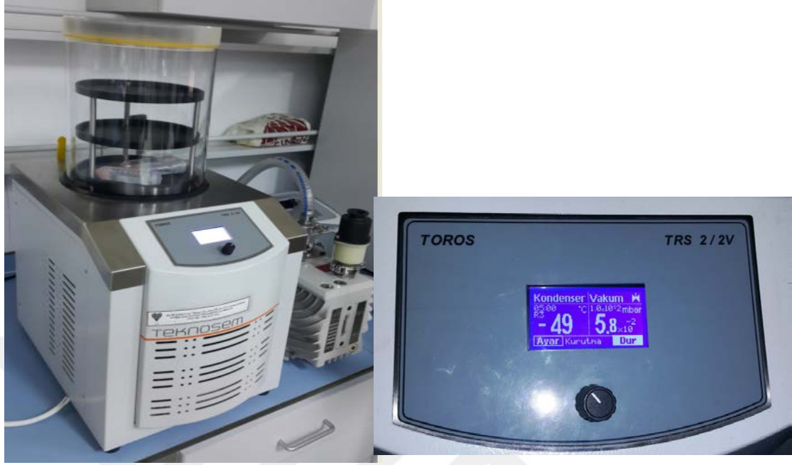
Şekil 3.2. Nanopartikülleri liyofilize eden dondurmalı kurutucu.
