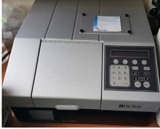
Şekil 3.12. Dox, ROS ve proteozom aktivitesinin ölçüldüğü spektrofotometre.
