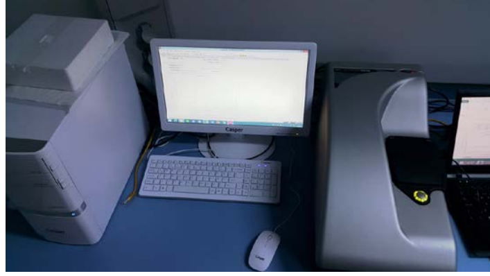
Şekil 3.3. Nanopartiküllerin boyutlarının ve zeta potansiyellerinin Zetasizer cihazı.
