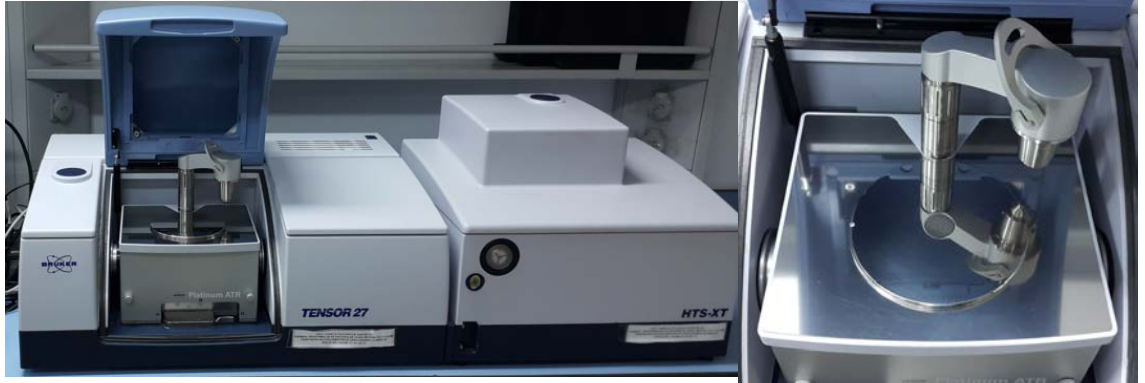
Şekil 3.5. Nanopartiküllerin İnfrared spektrumlarının alındığı FTIR spektroskopisi.
