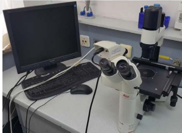
Şekil 3.14. Hücre görüntülerinin alındığı inverted mikroskop.
