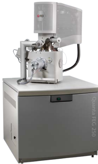
Şekil 3.4. Nanopartiküllerin boyutlarının görüntülediği SEM cihazı
