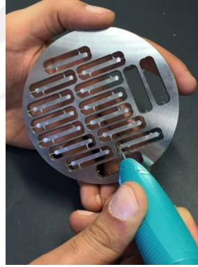
Şekil 3.22. Frezeleme işlemi tamamlanmış altyapı örneklerinin bulunduğu metal blok ve örneklerin bloktan ayrılması
