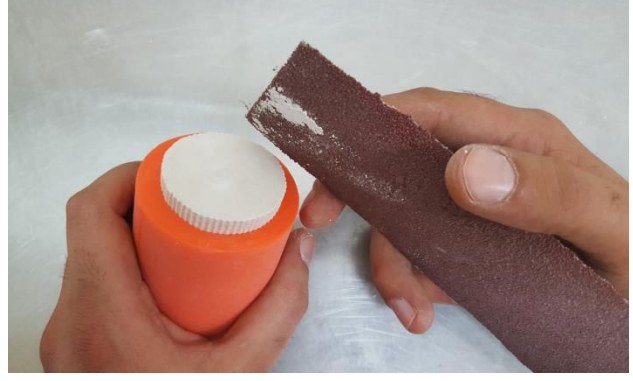
Şekil 3.9. Sertleşmesi ve soğuması tamamlanan revetmanın manşetten çıkarılma ve zımpara ile aşındırılma işlemi
