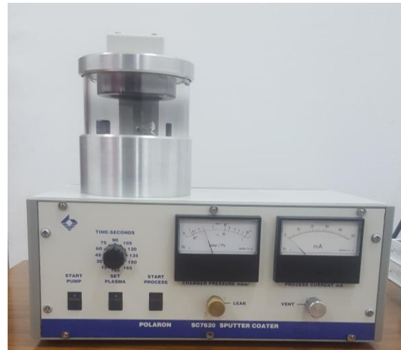
Şekil 3.41. Çalışmamızda kullanılan SEM ve altın kaplama cihazı
