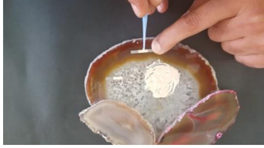
Şekil 3.30. Örneklere 1. opak seramiğinin uygulanması ve fırınlama işlemi
