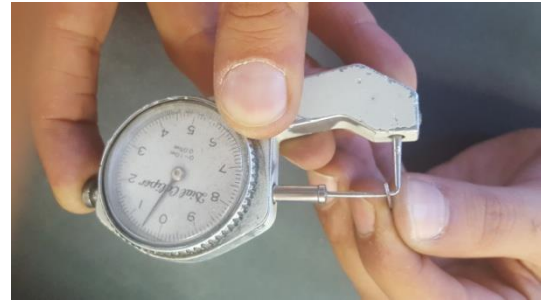
Şekil 3.23. Metal altyapı örneklerinin bağlantı noktalarının uzaklaştırılması ve mikrometre ile gerekli ebatların kontrol edilmesi
