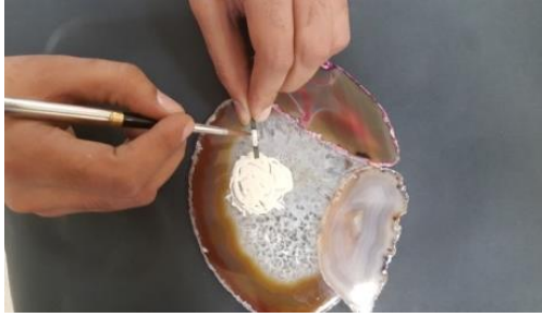
Şekil 3.31. Örneklere 2. opak seramiğinin uygulanması fırınlama işlemi
