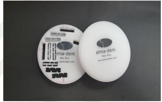
Şekil 3.2. CAD/CAM hazır mum blok ve frezeleme işlemi
