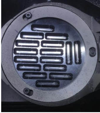
Şekil 3.22. Frezeleme işlemi tamamlanmış altyapı örneklerinin bulunduğu metal blok ve örneklerin bloktan ayrılması
