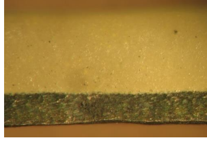
Şekil 4.4. CAD/CAM sistemi ile hazırlanan örneğin üç nokta eğme testi sonrası bağlantı bölgesinin görüntüsü
