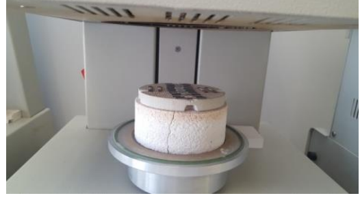
Şekil 3.30. Örneklere 1. opak seramiğinin uygulanması ve fırınlama işlemi
