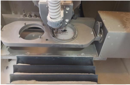
Şekil 3.2. CAD/CAM hazır mum blok ve frezeleme işlemi
