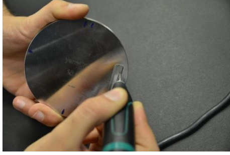
Şekil 3.19. CAD/CAM Co-Cr metal blok örneği
