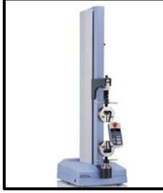
Şekil 3.37. Üç nokta eğme testinin yapıldığı üniversal test cihazı
