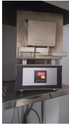
Şekil 3.10. Manşet ve seramik döküm potalarının yerleştirildiği ön ısıtma fırını
