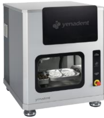
Şekil 3.20. Metal altyapı örneklerin hazırlanması için kullanılan bilgisayar destekli frezeleme ünitesi
