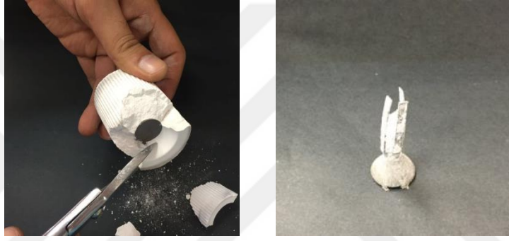
Şekil 3.13. Revetman kalıbın açılması
