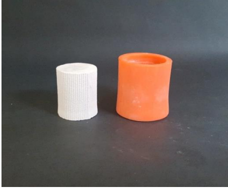
Şekil 3.9. Sertleşmesi ve soğuması tamamlanan revetmanın manşetten çıkarılma ve zımpara ile aşındırılma işlemi
