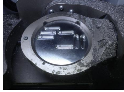
Şekil 3.21. Frezeleme ünitesine yerleştirilen metal bloğun frezelenme işlemi
