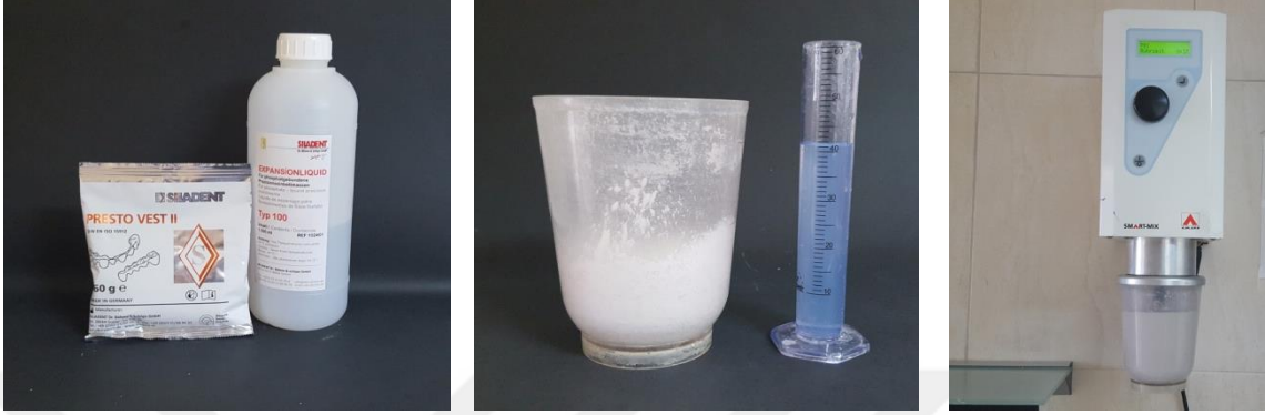
řekil 3.7. Manřet iine dklecek revetmanın hazırlanması ve karıřtırılması
