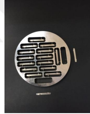
Şekil 3.22. Frezeleme işlemi tamamlanmış altyapı örneklerinin bulunduğu metal blok ve örneklerin bloktan ayrılması
