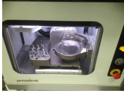
Şekil 3.21. Frezeleme ünitesine yerleştirilen metal bloğun frezelenme işlemi
