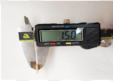
Şekil 3.4. PICN seramik örneklerin dijital kumpas ile kalınlıklarının ölçümü
