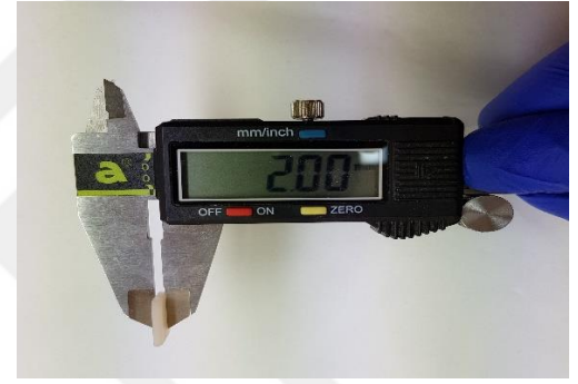
Şekil 3.4. PICN seramik örneklerin dijital kumpas ile kalınlıklarının ölçümü
