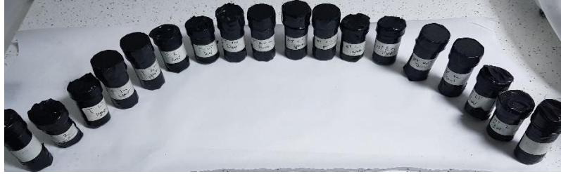
Şekil 3.10. Hazırlanan rezin siman örneklerinin saklandığı ışık geçirmeyen kaplar
