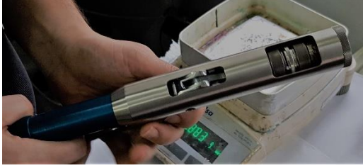
Şekil 3.13. Homojen hale getirilen KBr ve rezin simanın metal basınç aletine alınıp preslenerek 0,5 mm kalınlığında kristalize materyalin elde edilmesi
