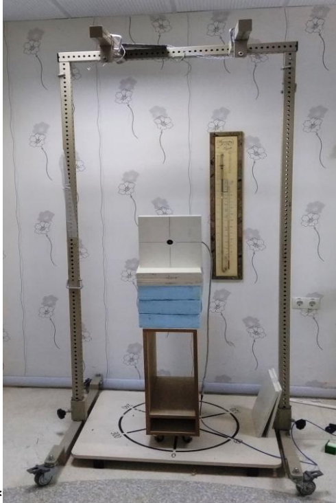
*Şekil 3.6. TCEI Tedavi platformunda profil, PDD ve output ölçüm düzeneđi
