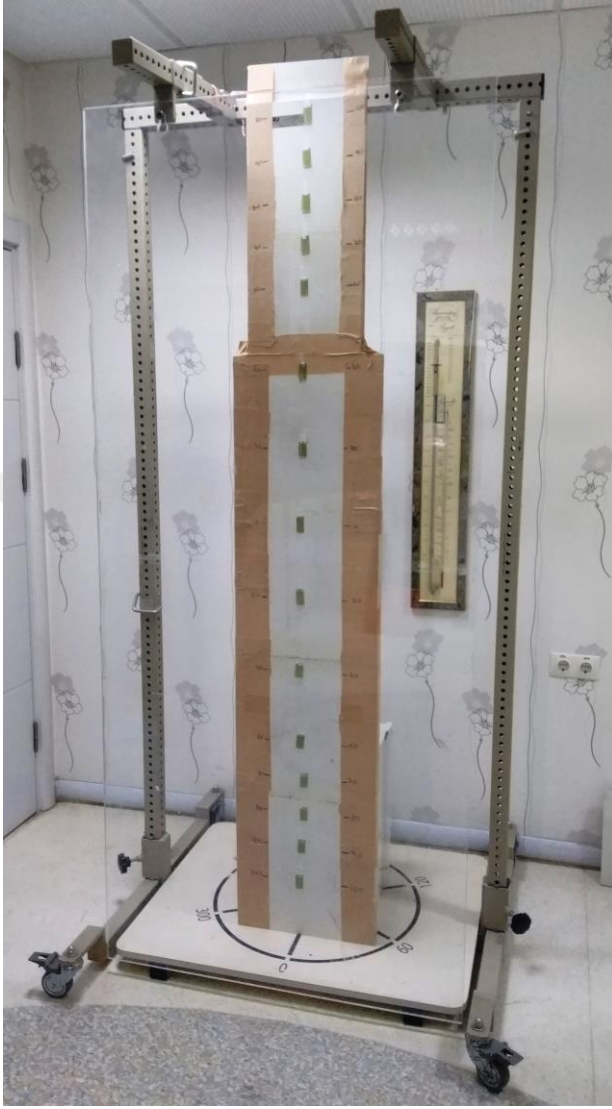
Şekil 3.7. Gantry açısının belirlenebilmesi için film ışınlama düzeneği
