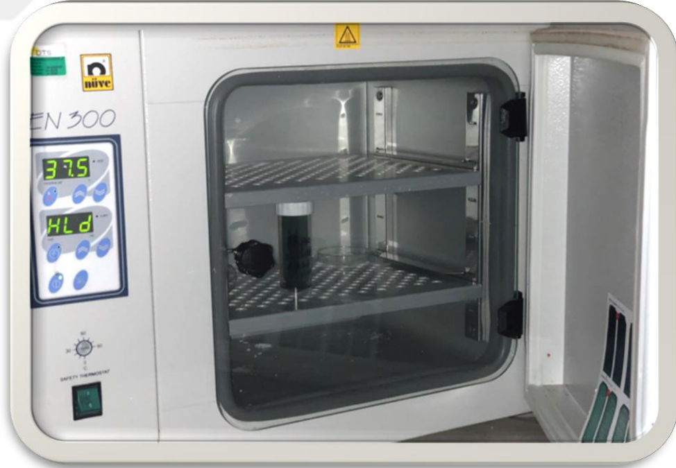
Şekil 3.4. CRT bakteri kitlerinin 48 saat süre, 37,5° sıcaklıkta bekletildiği etüv
