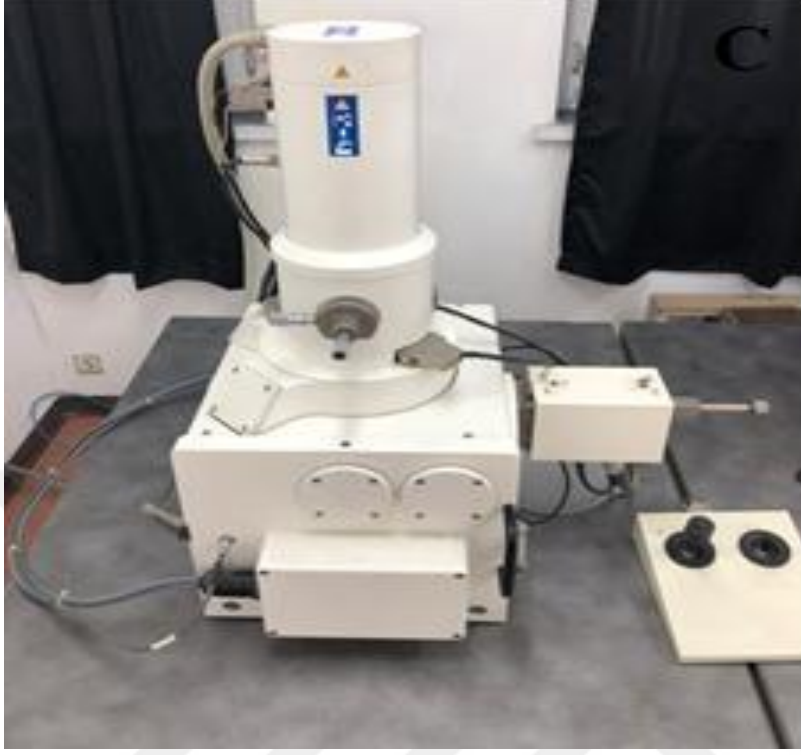
Şekil 3.21. Hazırlanan örneklerin SEM cihazında incelenmesi.
