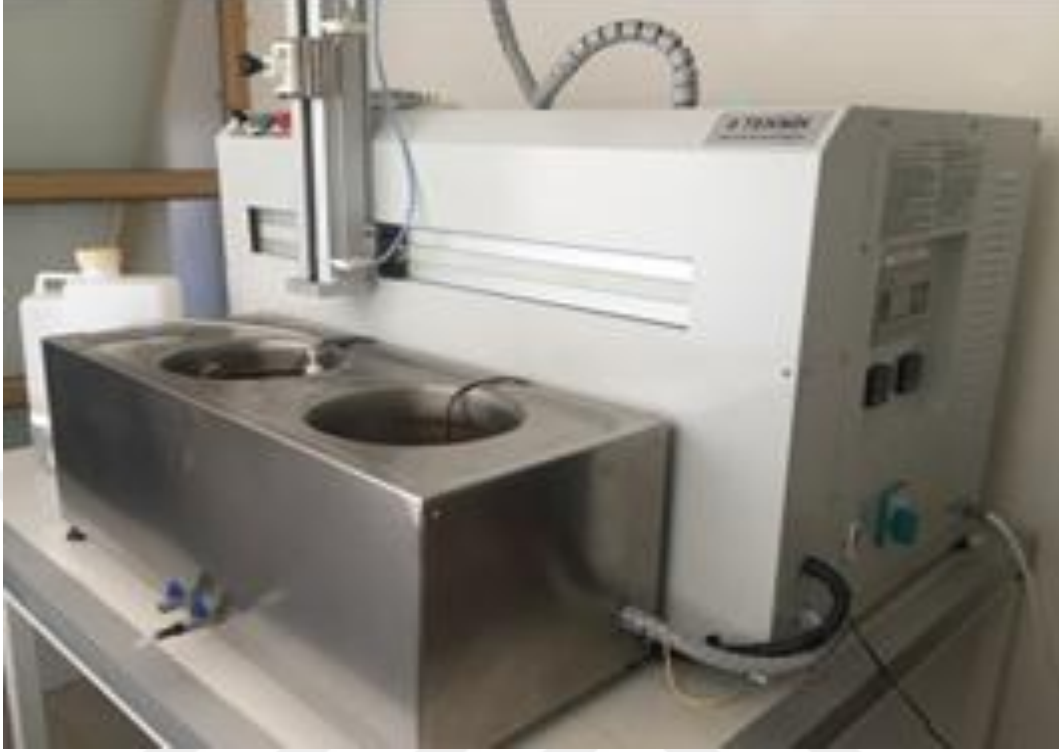
Şekil 3.15. Termal döngü cihazında örneklerin yaşlandırılması işlemi.
