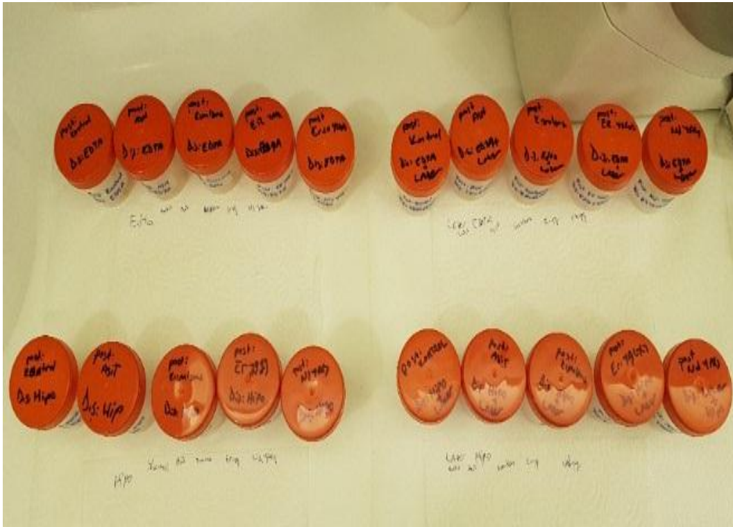
Şekil 3.14. Tüm simantasyon işlemlerinin tamamlanıp grupların akrilik bloklara gömülmeye hazır hale getirilmesi
