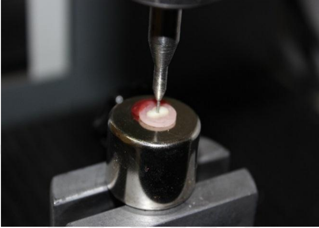
Şekil 3.18. İtme bağlanma dayanımı testinin uygulanımı.
