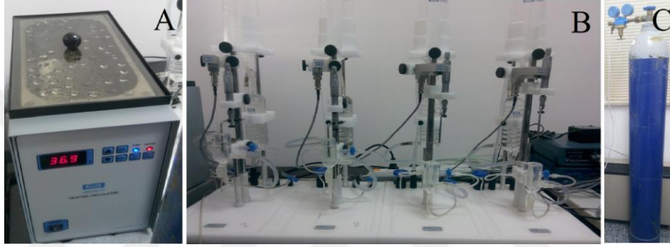
Şekil 3. 1. İzole organ banyosu sistemi.
