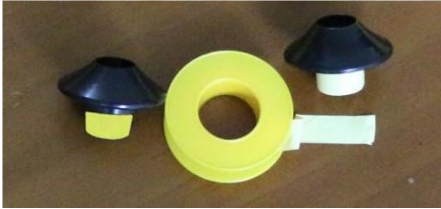
Şekil 1.19: Başparalere Sarılı Teflon Bant ve Kâğıt.
