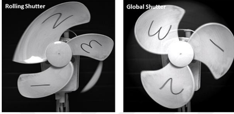
Şekil 57: Solda Rolling Shutter, Sağda Global Shutter
