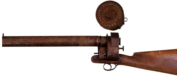
Şekil 17: Fotoğraf tüfeği (photographic gun). Etienne-Jules Marey. 1882 Kaynak: Bodur, 2013, s.16.
