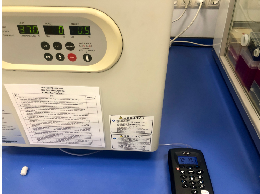
Şekil.3.5. Deneyde kullanılan inkübatörün oksijen ayarı 0.5'e ayarlandığında inkübatör içi oksijen seviyesinin ölçümü gaz analizörü kullanılarak (GEOTECH, G100) %0 olarak belirlendiğini gösteren fotoğraf.
