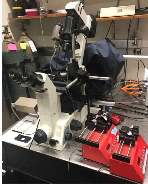
Şekil 3.1. Kültür medyumunu değişimi için yapılması tasarlanan sistemin şematik çizimi. Kültür medyumunu değişim sisteminde kültür medyumunun değişimini sağlamak üzere A ve B olmak üzere iki adet giriş pompası ve bir adet çıkış pompası bulunmaktadır. Sistemin çalışma prensibi; petri kabına sabitlenmiş olan giriş ve çıkış pompalarının bağlantısını sağlayan iğneler aracılığıyla, embriyoların içerisinde bulunduğu 50 \mu L'lik damlacık içindeki medyumun istenilen içerikle değişiminin gerçekleşmesine dayanmaktadır.
