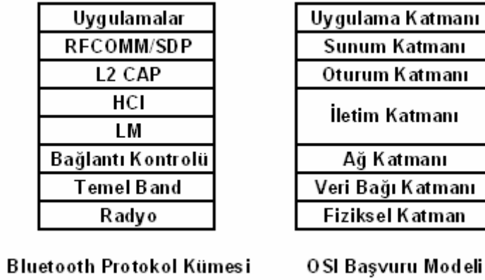
Şekil 3.15. Bluetooth protokol kümesi ve OSI referans modeli
