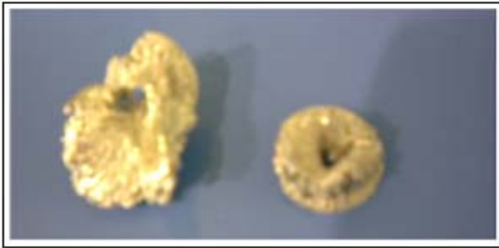
Resim 5.1. Nozul çıkıntısı ucunda meydana gelen metal yığılmaları
