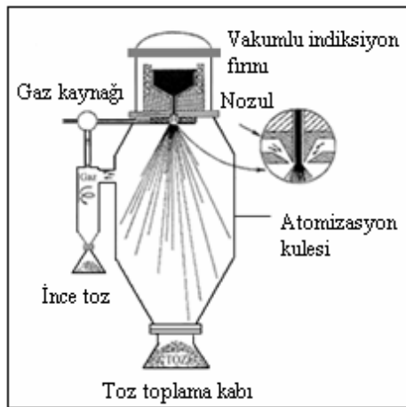
Şekil 3.2. Düşey gaz atomizasyon ünitesi [32].
