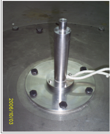
Resim 4.6. Akış memesi-çıkıntı aparatı - nozul bağlantısı
