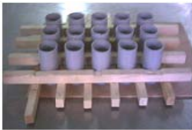
Resim 3.6. Betonarme numune üretimi için hazırlanan kalıp düzeneği
