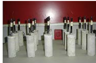
Resim 3.7. Üretilen betonarme numuneler
