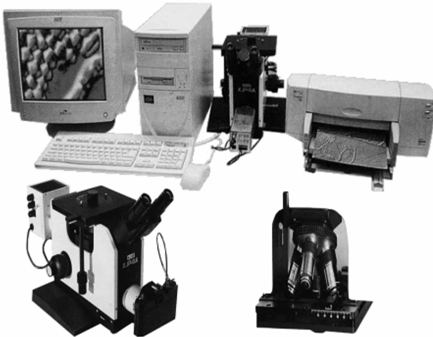
Resim 3.7. Trinoküler metal foto mikroskobu
