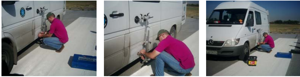
Resim 5.2. Deney ekipmanlarının deney taşıtına montajı
