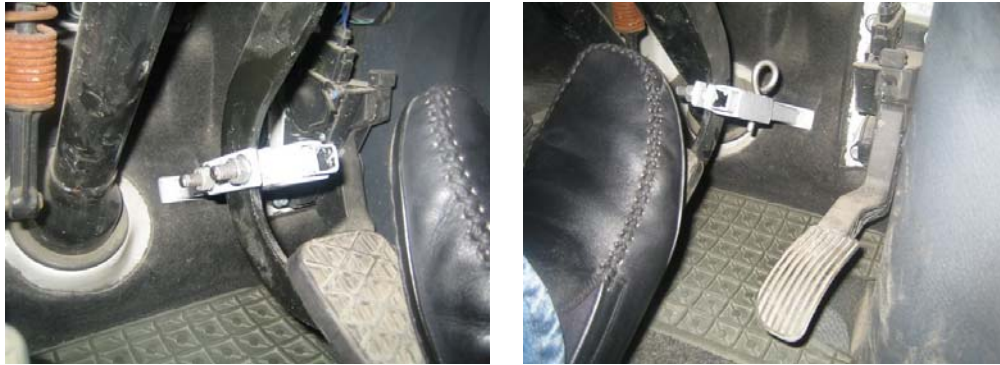
Resim 4.7. Pedal kuvveti sınırlayıcı aparatın fren pedalına montajı
