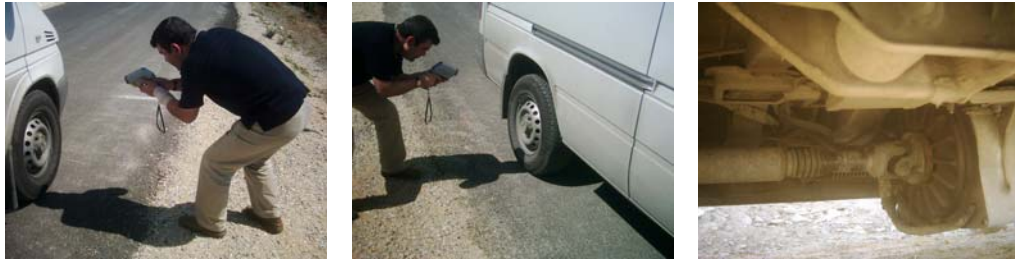
Resim 5.1. Termocouple ile disk sıcaklığı ve yavaşlatıcı sıcaklığının ölçülmesi
