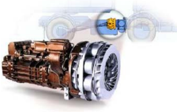
Şekil 3.14. Elektromanyetik yavaşlatıcının şanzıman arkasına montajı [69]
