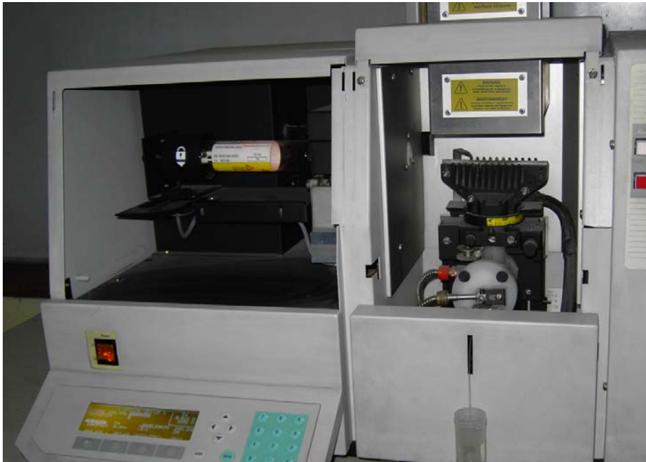
Resim 6.2. Alev adsorpsiyon spektrofotometresi
