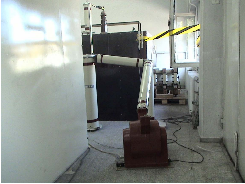
Şekil 5.3. Tasarlanan elektrostatik toz tutucunun besleme ekipmanları
