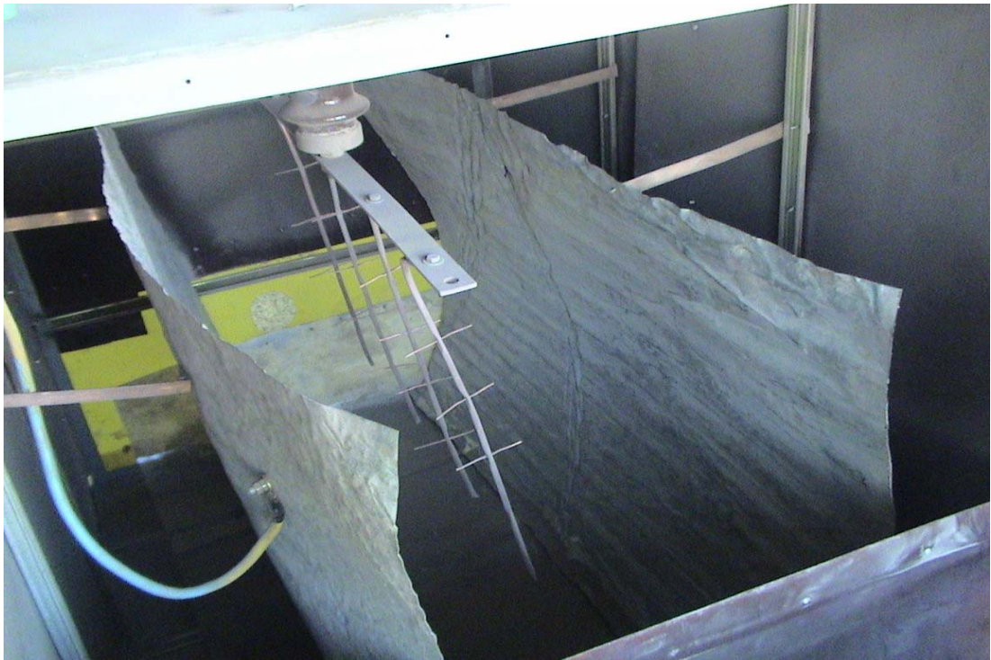
Şekil 5.2. Tasarlanan elektrostatik toz tutucunun iç görünümü
