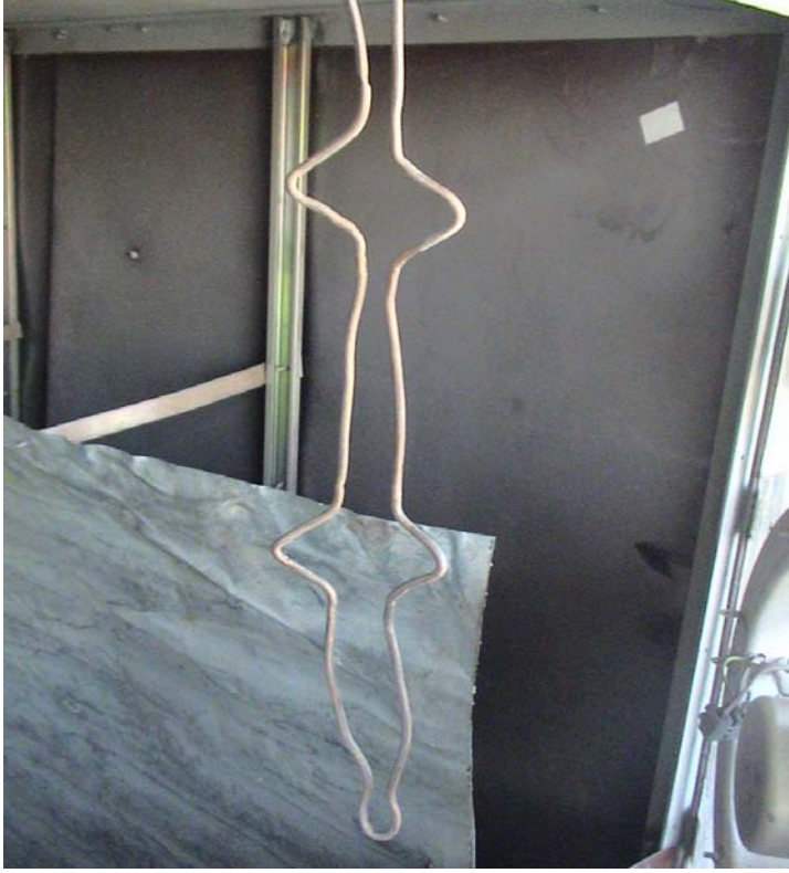
Şekil 5.5. Yuvarlak uçlu boru tipi yükleme elektrodu
