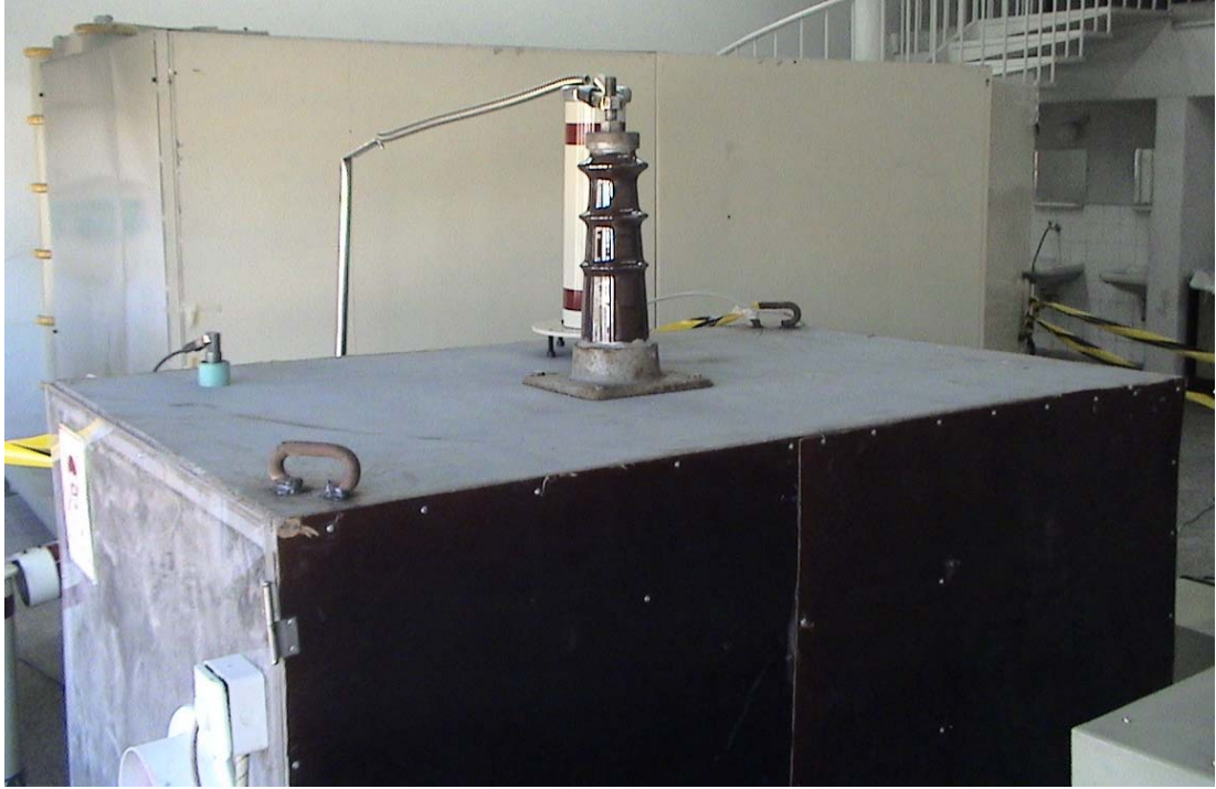
Şekil 5.1. Tasarlanan elektrostatik toz tutucunun dış görünümü
