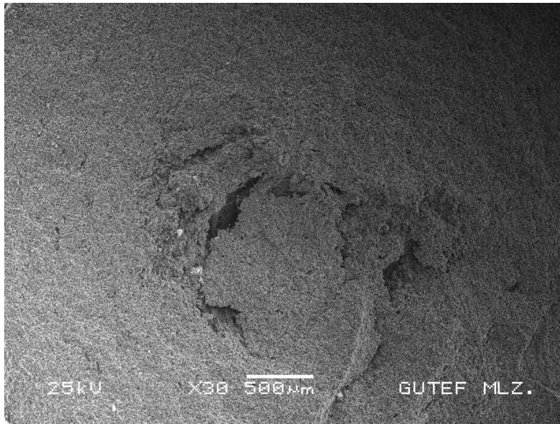
Resim 4.15. Çekme numuneleri kırılan yüzey görüntüleri a) Isıtma rejimi 1 b) Isıtma rejimi 3
