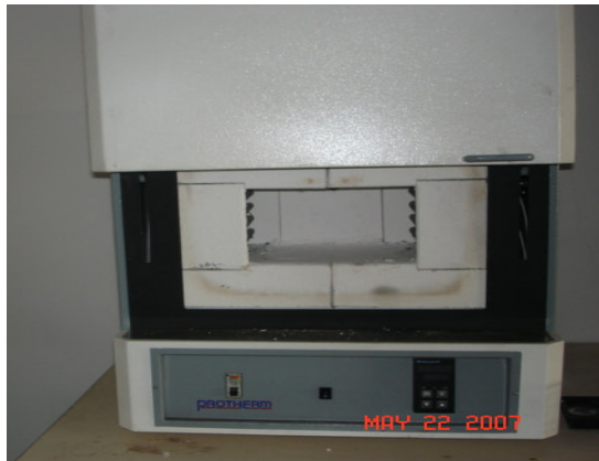
Resim 4.6. Protherm markalı bağlayıcı giderme işleminde kullanılan fırın
