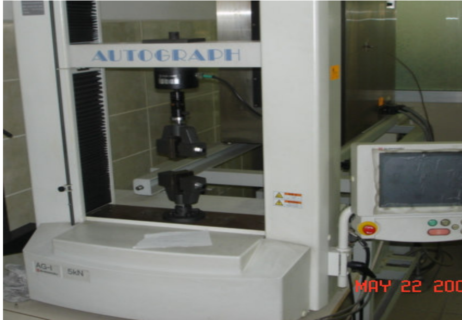
Resim 4.10. Schimadzu markalı çekme ve eğme deneylerinin gerçekleştirildiği cihaz
