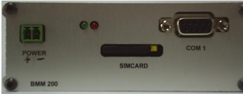
Resim 5.2. Paket anahtarlama radyo hizmetleri modemi RS232 bağlantısı
