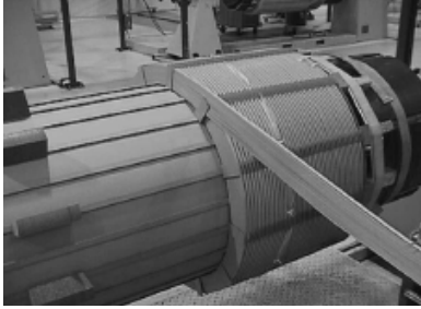
Resim 3.2. Sipiral (Heliksel) sargının sarılması [15]
