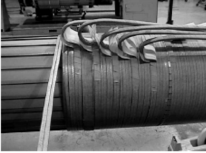
Resim 3.1. Tek tabakalı ve paralel iki kısımlı tabakalı sargının sarılması [14]
