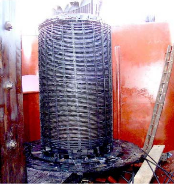
Resim 6.2. Aksiyal dağılma yaşamış trafo bobini [48]
