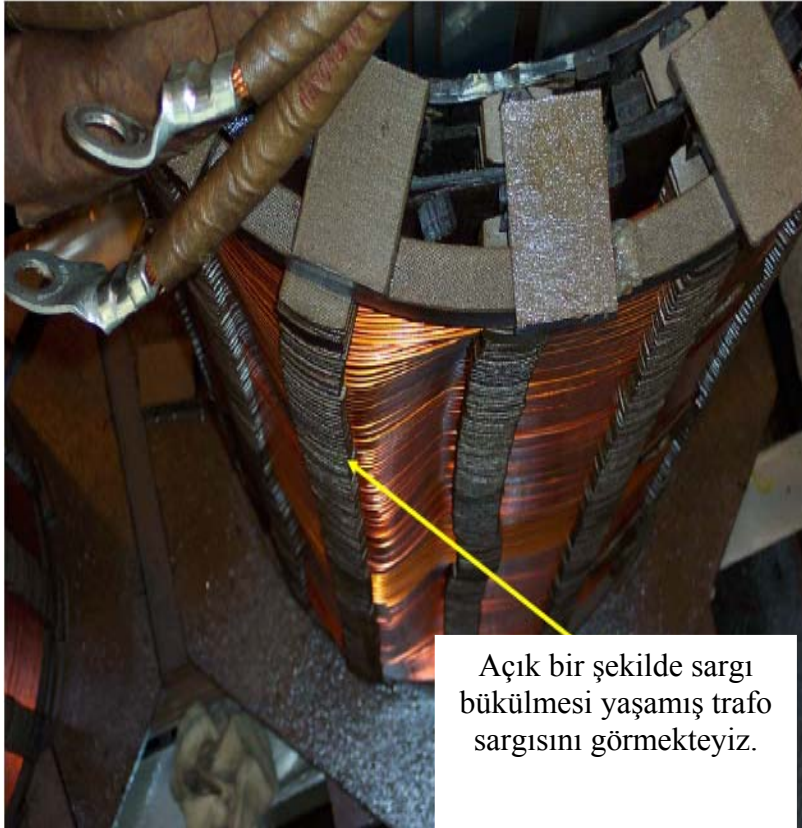
Resim 6.4. Radyal kuvvetlerin tesirinde meydana gelen sargı bükülmesi [49]
