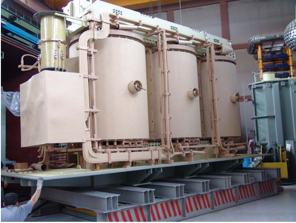
Resim 2.1. Üç fazlı bir transformatörde etkin kısım, manyetik devre ve sargılar [6]
