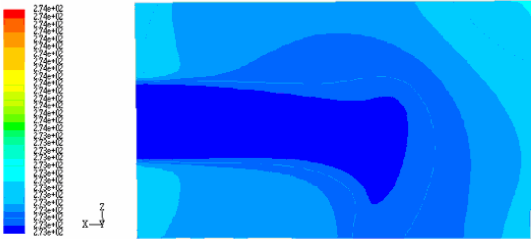
Şekil 5.38. Kış şartlarında 1,5 m/s rüzgâr hızı olduğu olduğunda 120. saniyede 1. durumdaki odanın ortasından geçen yatay düzlemdeki (XZ düzlemi) sıcaklık dağılımı
