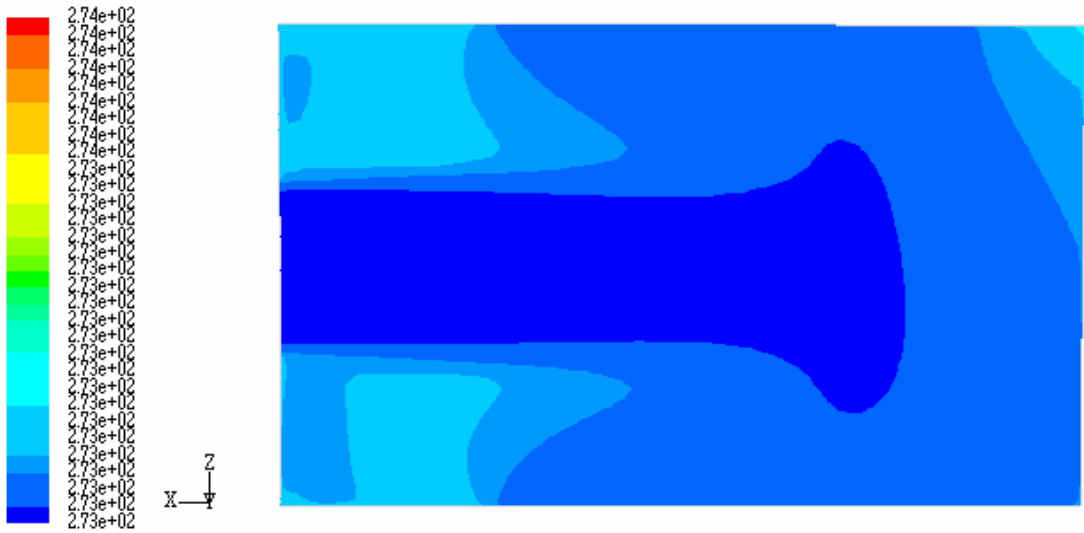
Şekil 5.63. Kış şartlarında 1 m/s rüzgâr hızı olduğu olduğunda 120. saniyede 2. durumdaki odanın ortasından geçen yatay düzlemdeki (XZ düzlemi) sıcaklık dağılımı
