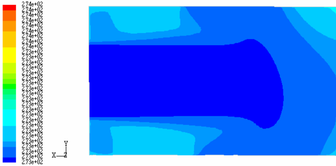
Şekil 5.61. Kış şartlarında 1 m/s rüzgâr hızı olduğunda 120. saniyede 2. durumdaki odanın ön pencerenin ortasından geçen düşey düzlemdeki (XY düzlemi) sıcaklık dağılımı
