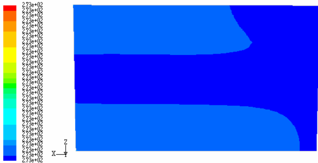
Şekil 5.73. Kış şartlarında 1,5 m/s rüzgâr hızı olduğu olduğunda 120. saniyede 2. durumdaki odanın ortasından geçen yatay düzlemdeki (XZ düzlemi) sıcaklık dağılımı
