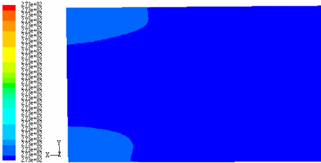
Şekil 5.71. Kış şartlarında 1,5 m/s rüzgâr hızı olduğunda 120. saniyede 2. durumdaki odanın ön pencerenin ortasından geçen düşey düzlemdeki (XY düzlemi) sıcaklık dağılımı
