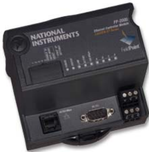
Resim 3.3. NI FP-2000 akıllı ethernet kontrol arayüzü
