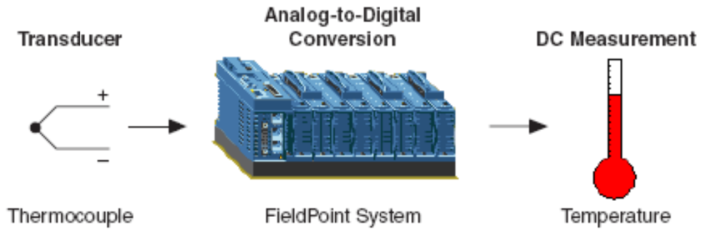
Şekil 3.13. Sıcaklık ölçümü için kullanılan FieldPoint sistemi
