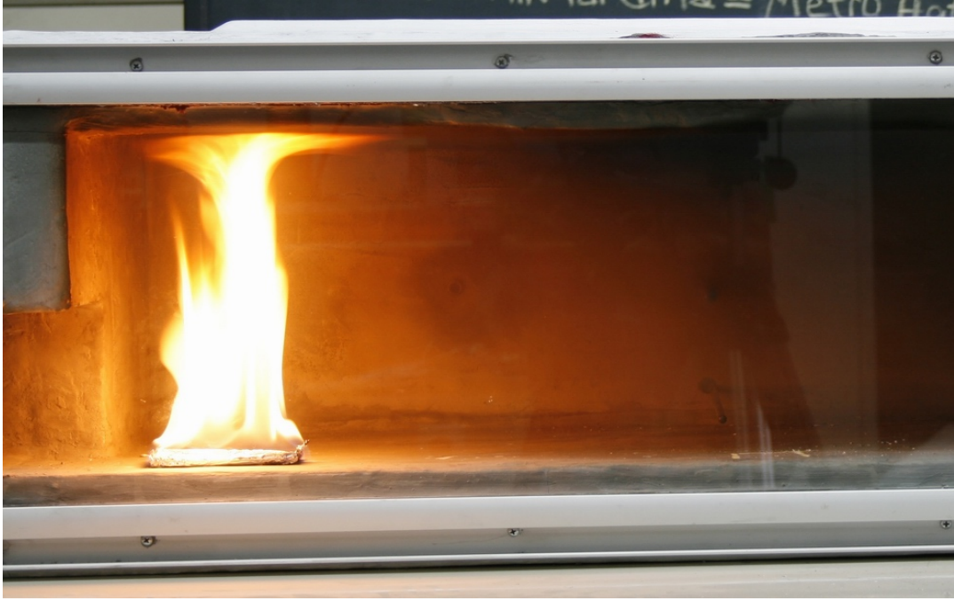
Resim 3.40. İso-propil alkol alevinin istasyon tavanına çarpması
