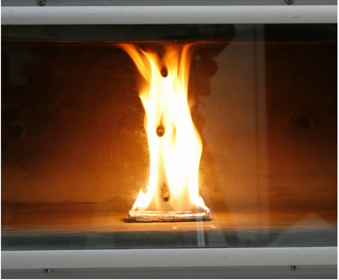
Resim 3.46. 10 cc iso-propil alkol - istasyon merkezi kararlı (steady) yanma
