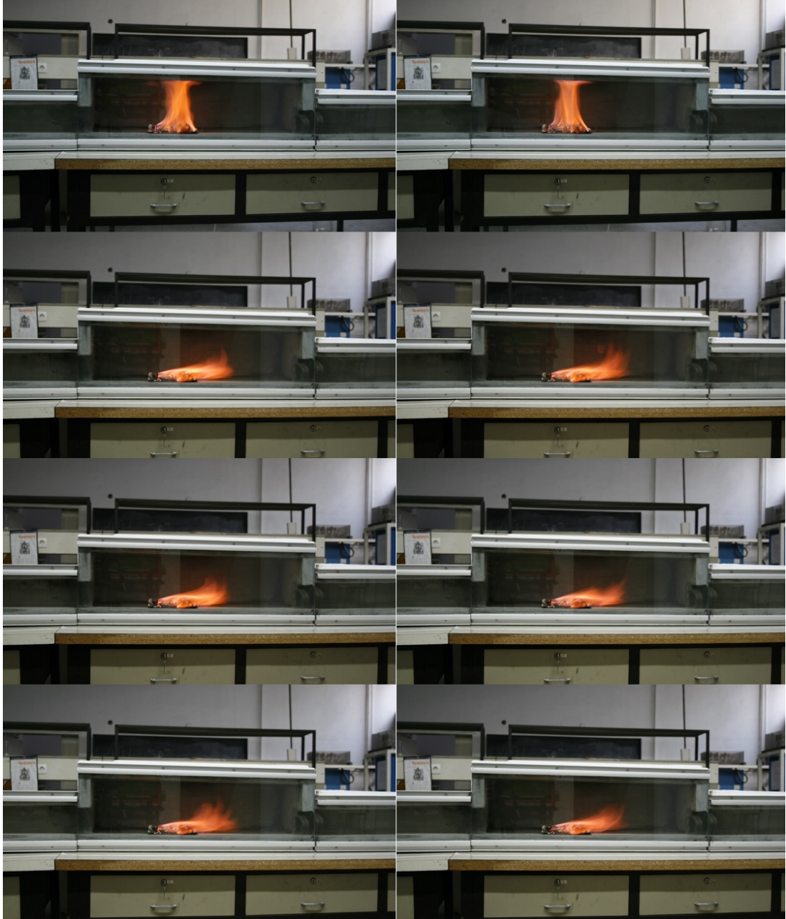
Resim 3.36. Durađan haden yksek ventilasyona ani geiř durumu
