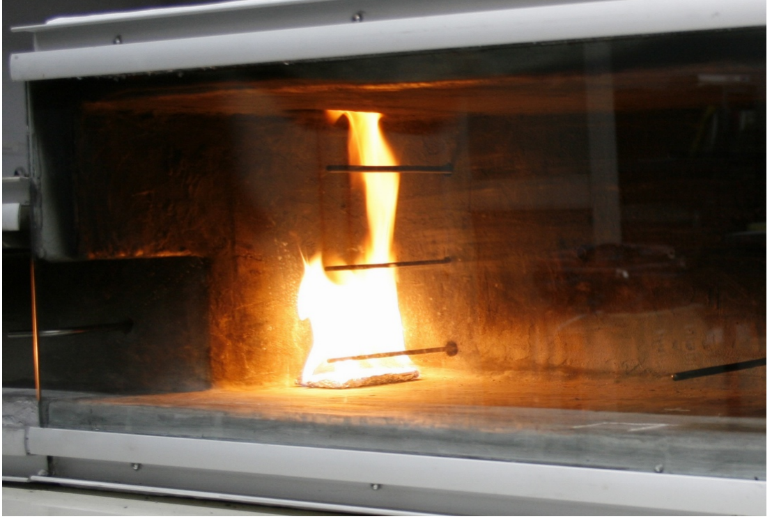
Resim 3.66. Giriş duvarı konumunda n-heptan yangını başlangıcı
