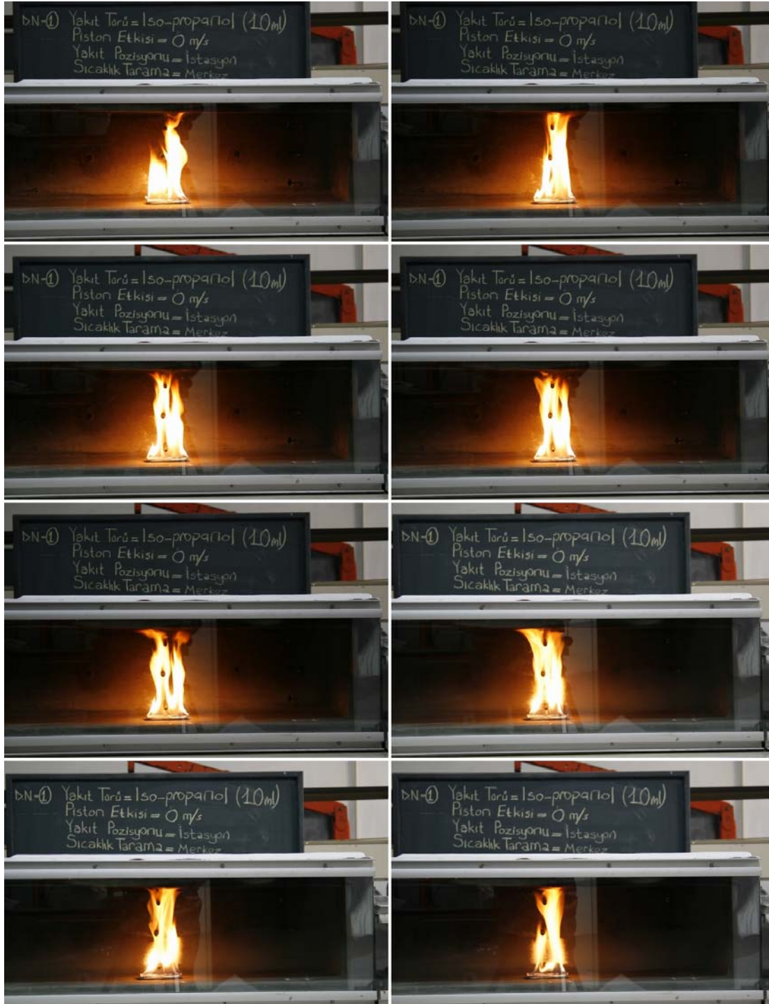
Resim 3.45. 10 cc iso-propil alkol yakıtlı istasyon merkezi yangını (ventilasyon yok)
