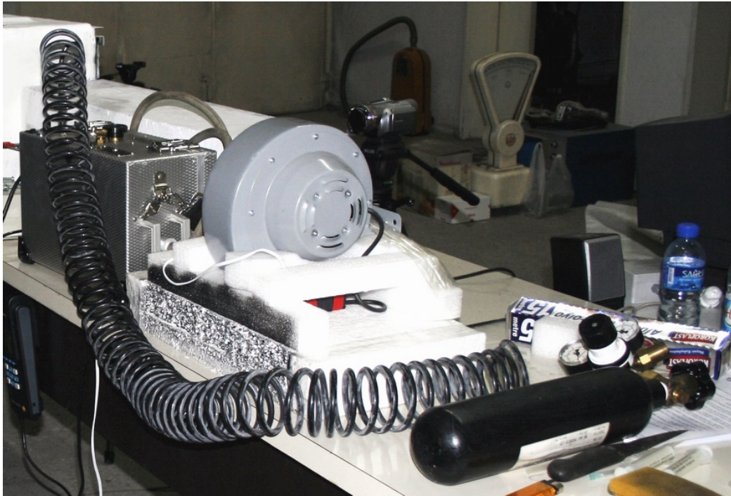
Resim 3.37. Duman makinası ve itici gaz sistemi
