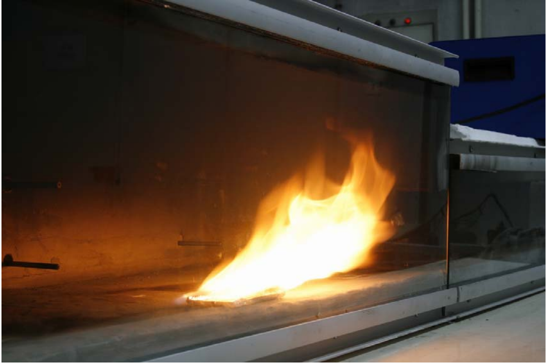
Resim 3.51. 10 cc iso-propil alkol - hat merkez (1 m/s piston etkisi)
