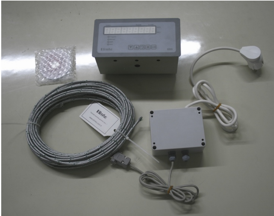
Resim 3.17. Elimko kontrol ünitesi, bilgisayar bağlantı ünitesi, yazılım disk ve kablolar
