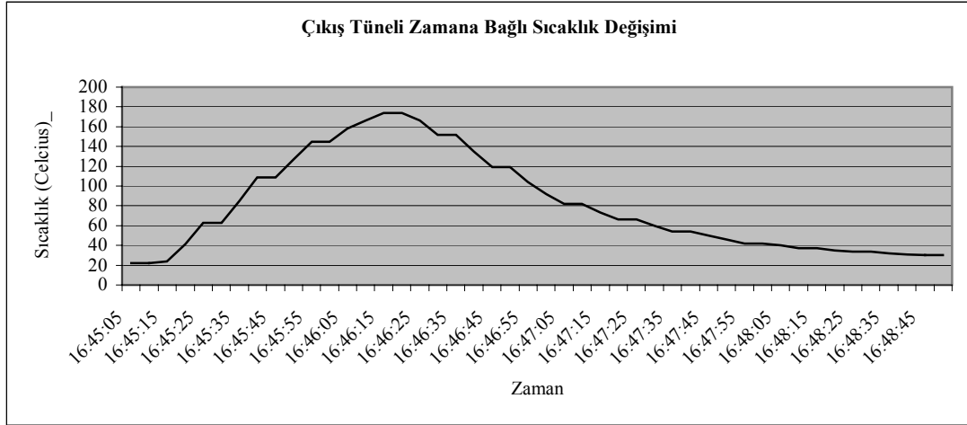
Şekil 3.35. Hat çıkış yangını için çıkış tüneli zamana bağlı sıcaklık değişimi (1 m/s piston hızı)
