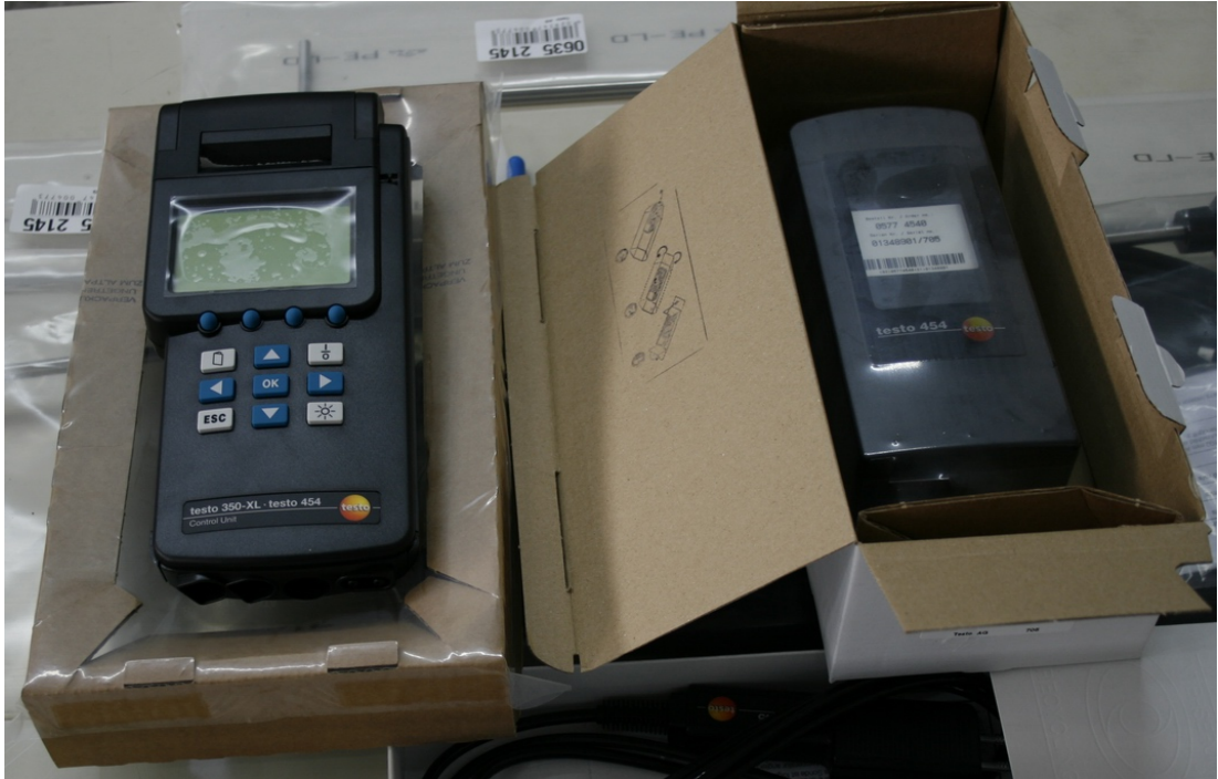
Resim 3.22. Testo-350XL/454 kontrol ünitesi ve Testo-454 logger
