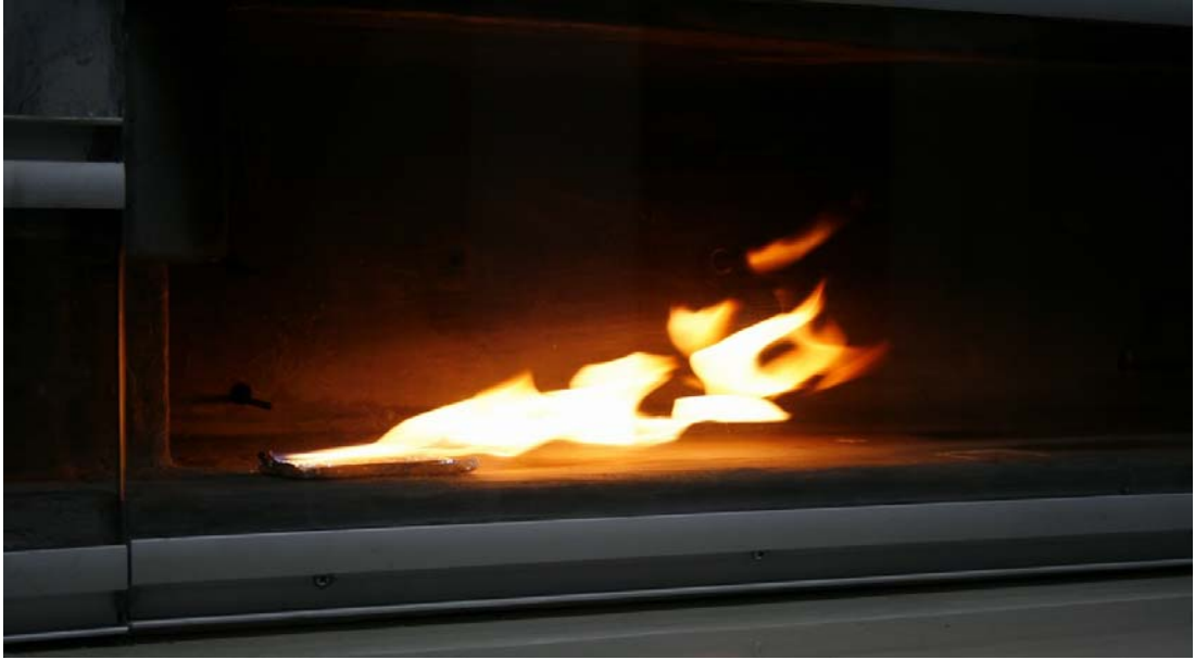
Resim 3.48. 10 cc iso-propil alkol - hat giriř (1 m/s piston etkisi)
