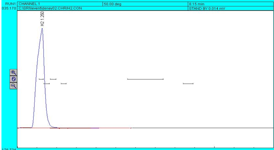
Şekil 5.1. Reaktör 425 °C sıcaklıkta iken alınan ürün gazın GC analizi
