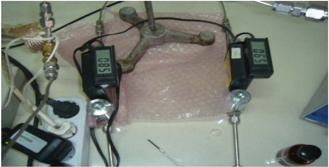
Resim 2.2. Gaz akış hızlarının ayarlanmasında kullanılan kütle akış ölçerler
