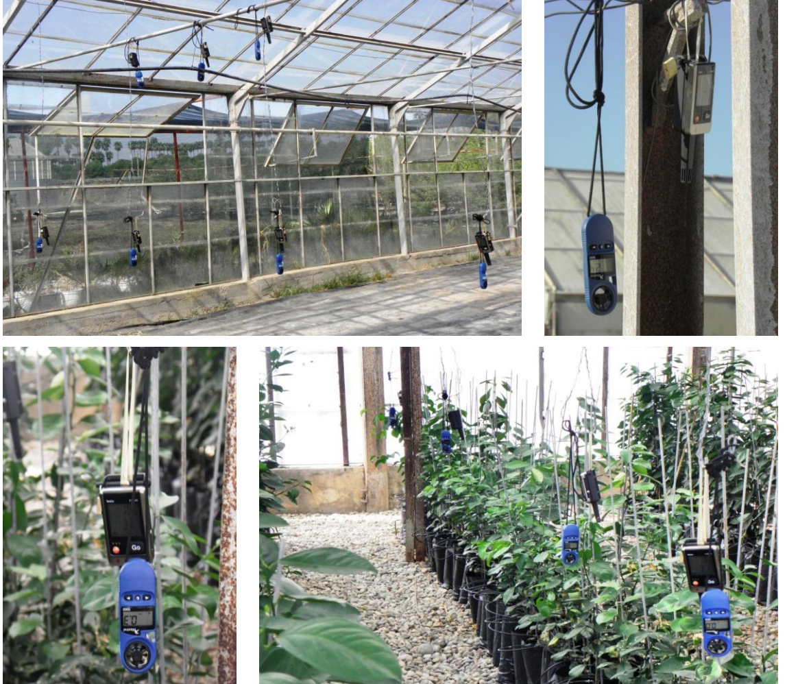
Şekil 3.4. Sıcaklık, nem ve rüzgar hızı ölçerlerin seralara yerleştirilmesi
