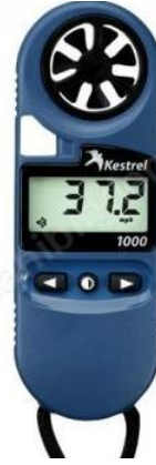
KESTREL 1000 Anemometre (Sadece Rüzgar Hızı Ölçer)
