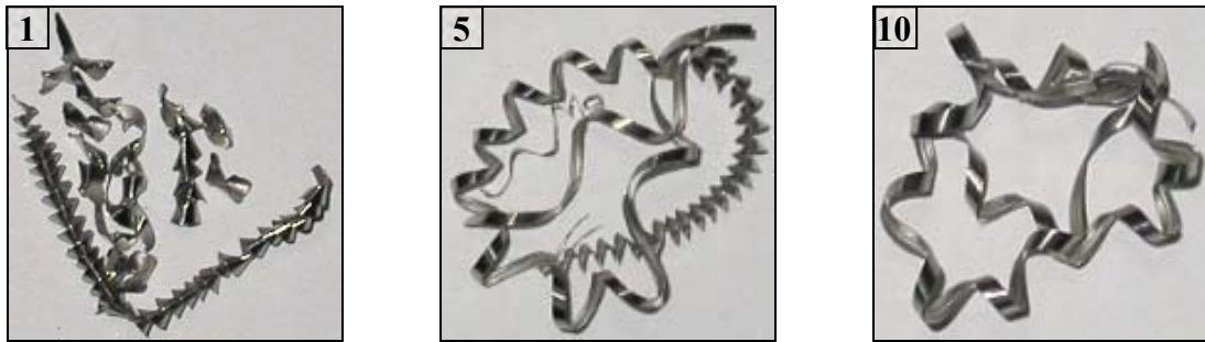
Şekil 6.19. Bir takım ile yapılan deneyde ilk delik, ortadaki ve son delikten alınan talaş örnekleri
