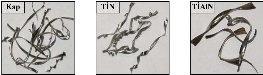
Şekil 6.20. 17,5 m/min kesme hızı ve 0,1 mm/rev ilerleme miktarında üç farklı takımdan alınan talaş örnekleri
