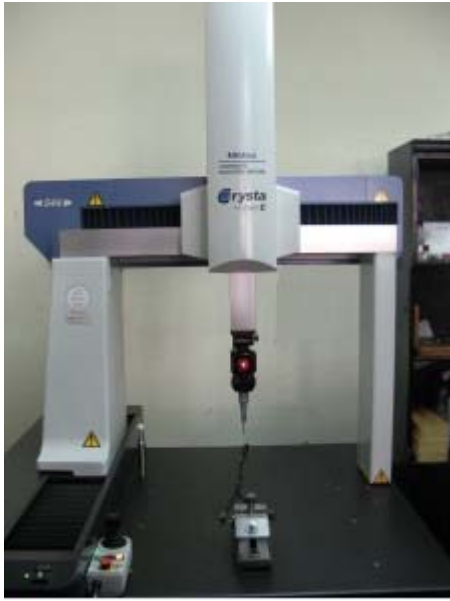
Resim 5.4. Delik çap ve daireselliklerinin ölçüldüğü CMM tezgahı
