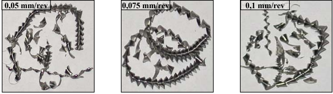
Şekil 6.22. 12,5 m/min kesme hızında ilerleme miktarına bağlı olarak kaplamasız takımla delinen ilk deliklerden alınan talaş örneklerindeki değişim
