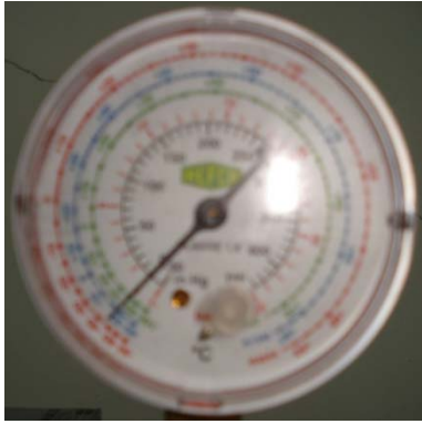
Resim 4.5. Yüksek basınç manometresi
