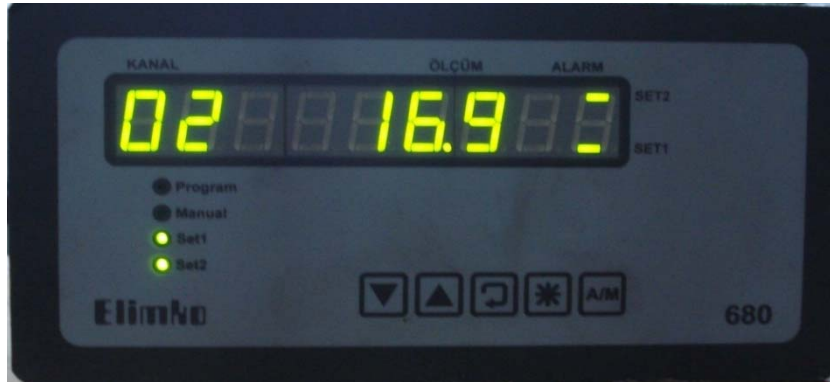
Resim 4.4. Elimko E – 680 serisi universal girişli gelişmiş tarayıcı
