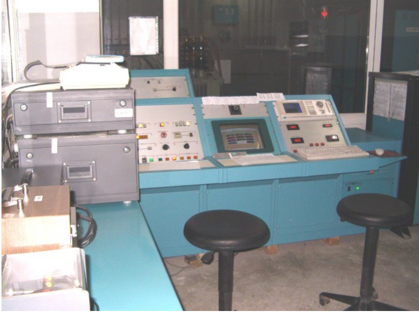
Resim 3.5. Transformatörün bilgisayarlı analiz ve testi cihazı
