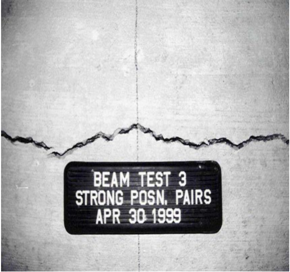
Resim 4.5. Test 3 giriş boyunca oluşan çatlaklar [3]
