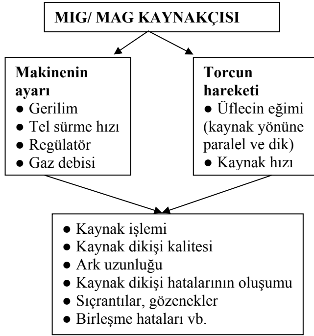
Şekil 3.3. Kaynak parametrelerinin kaynak kalitesine etkisi[2]
