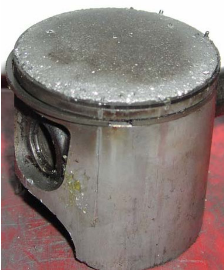
Resim 2.1. Vuruntulu yanma sonucunda, vuruntunun piston üzerin de yapmış olduđu tahribat [13].
