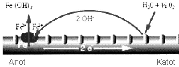
Resim 2.1. Çelik bir boru üzerinde korozyon oluşumu
