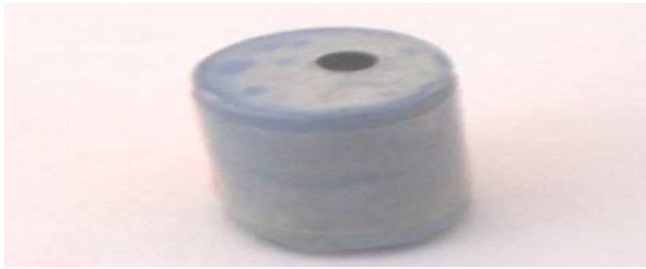
Resim 3.4. Potansiyel taramalı polarizasyonla Pani kaplanan çelik elektrotların genel görüntüsü
