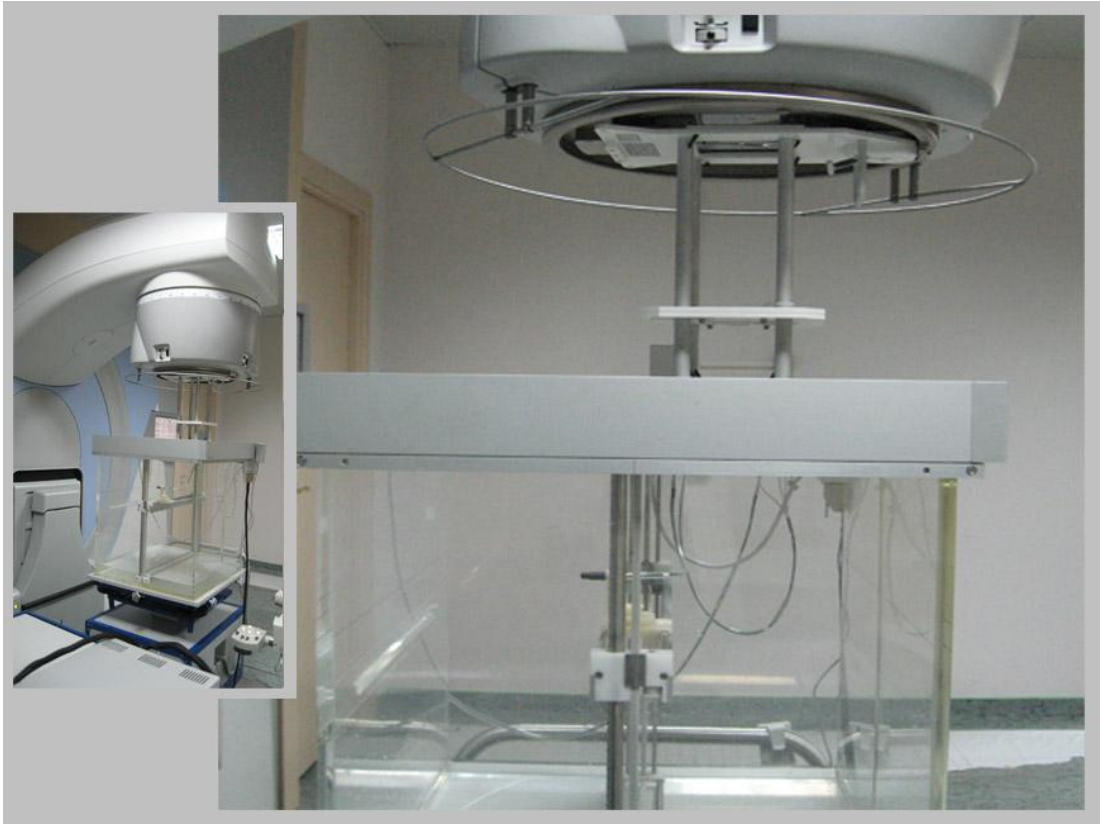
Resim 6.3. Doğrusal hızlandırıcı cihazında, elektronlar için havada ölçüm almaya hazır hale getirilmiş su fantomu düzeneği
