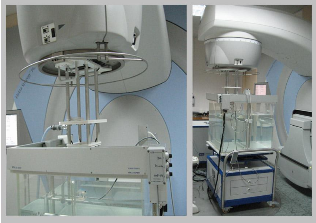
Resim 6.1. Doğrusal hızlandırıcı cihazında elektronlar için suda ölçüm almaya hazır hale getirilmiş su fantomu düzeneği
