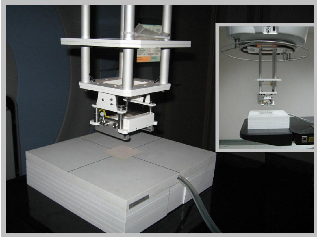
Resim 6.2. Doğrusal hızlandırıcı cihazında elektronlar için ölçüm almaya hazır hale getirilmiş katı fantom düzeneği
