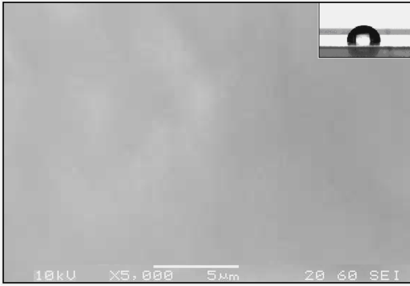
Resim 5.6. Düzgün PS yüzeyinin taramalı elektron mikroskobu ile çekilmiş resmi.
