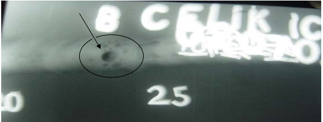
Resim 9.16. Yakıp delme radyografik film görüntüleri
