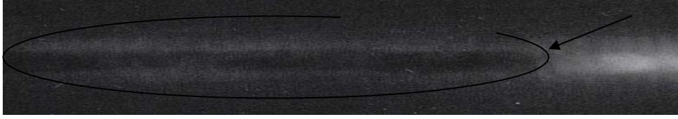
Resim 9.13. Kökte içbükeylik radyografik film görüntüsü
