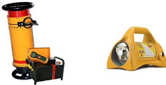
Resim 9.1. Deneylerde kullanılan Baltospot x ışını cihazı ve Sentinel 880 Delta gama ışını cihazı
