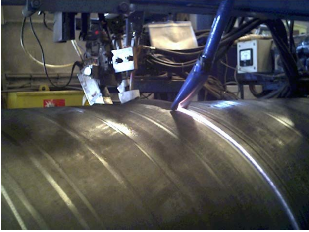
Resim 9.5. Spiral kaynaklı elik borunun dıř kaynađı
