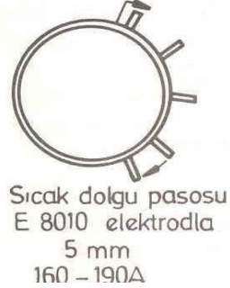
Şekil 5.3. Boru hatlarında bir contada yukarıdan aşağıya kaynak halinde pasoların görünüşü [51]
