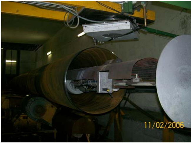
Resim 9.2. Tozaltı kaynaklı spiral boruların radyoskopi tekniği ile yapılan kontrol işlemi
