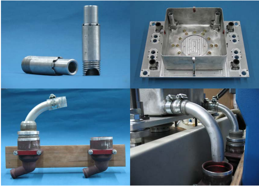
Resim 5.11. Dielektrik sıvı seviye kontrol ve tahliye borusu
