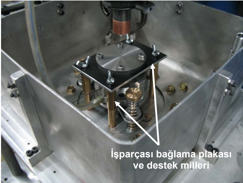
Resim 8.2. İT-EEİ tekniđinde kullanılan titreşimsiz işleme koşulları
