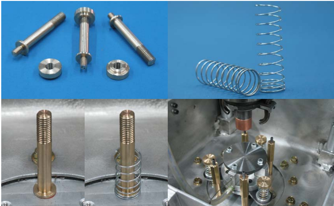
Resim 7.18. Statik yük dengeleyici yay ve kılavuz mili
