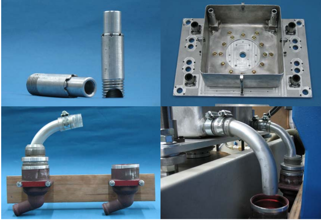
Resim 7.14. Dielektrik sıvı seviye kontrol ve tahliye borusu
