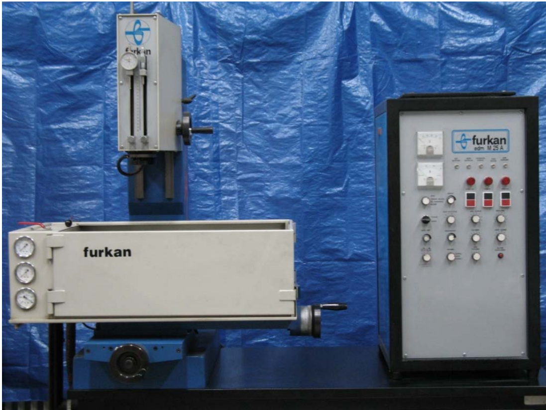
Resim 3.3. EDM M 25 A elektro erozyon tezgahı
