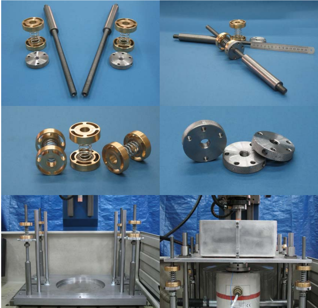
Resim 5.14. Statik yük dengeleyici yay ve vidalı kılavuz mil
