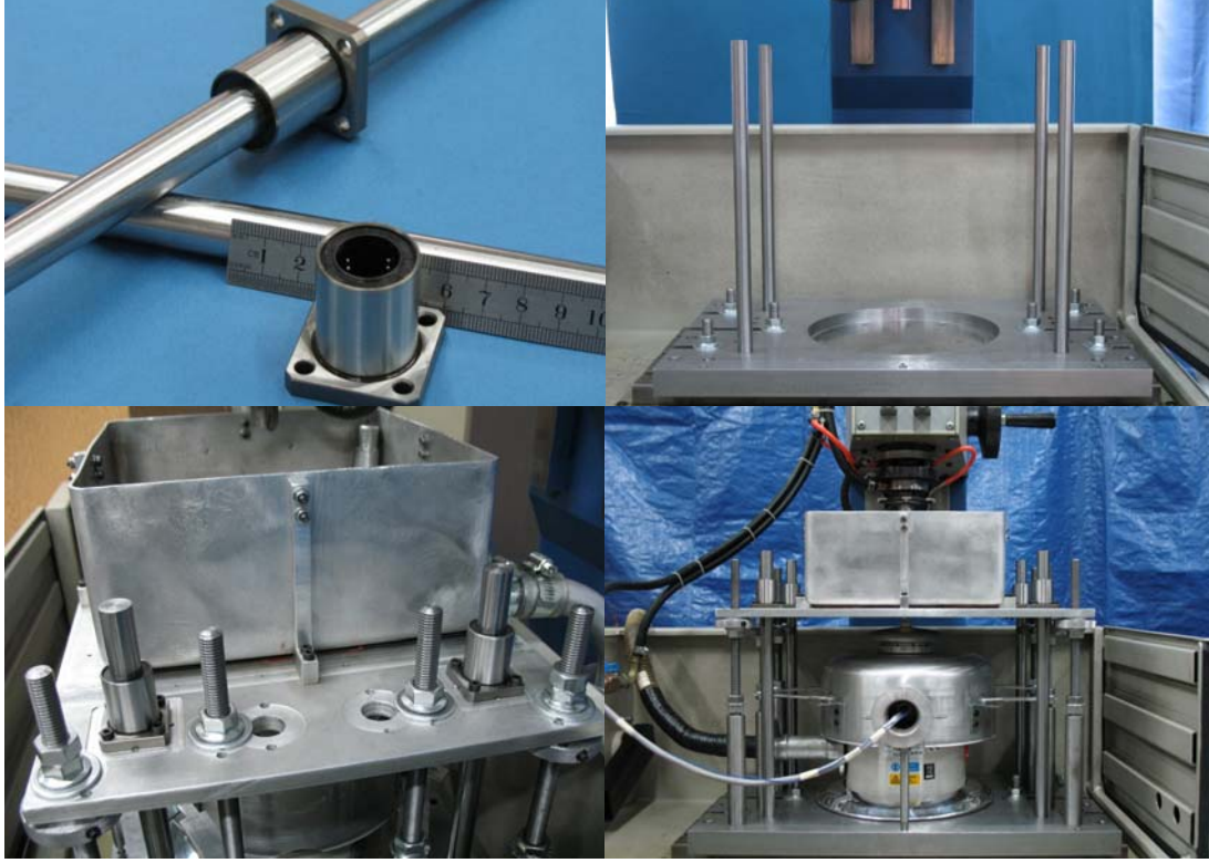
Resim 7.6. Lineer rulman ve kılavuz mil
