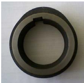
Resim 6.1. Kam taşlama tezgahında kullanılan kam şablonu
