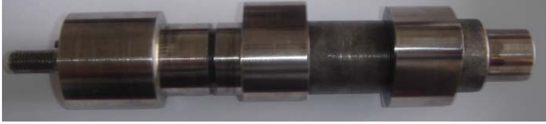
Resim 6.2. 130° supap açık kalma süresine sahip kam mili
