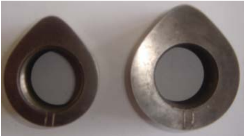
Resim 6.6. Tel erozyon ile kesilen 2,164 radyan ( 124^\circ ) supap açık kalma süresine sahip emme ve egzoz kam profilleri
