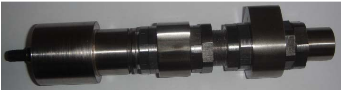
Resim 6.3. İmalatı yapılan kam mili ve üzerindeki kamlar
