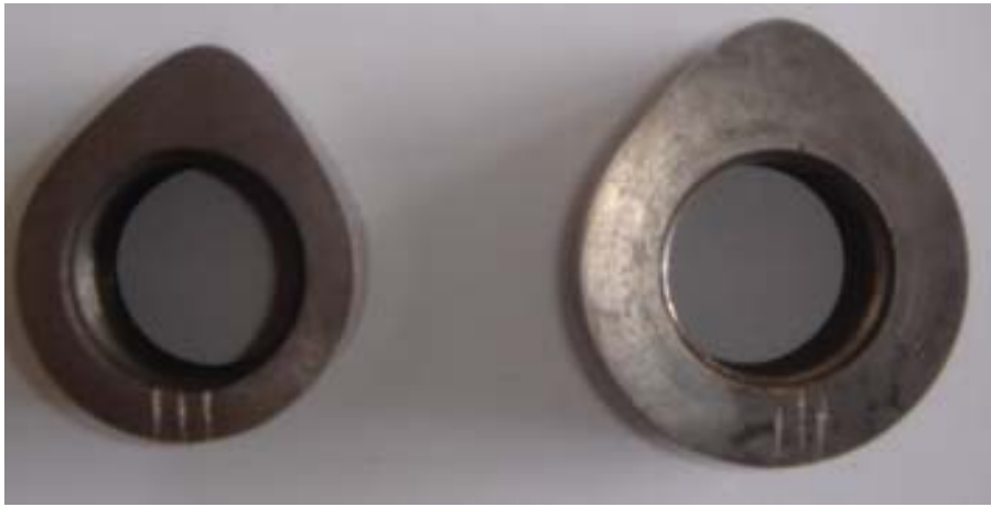
Resim 6.7. Tel erozyonda kesilen 2,234 radyan ( 128^\circ ) supap açık kalma süresine sahip emme ve egzoz kam profilleri
