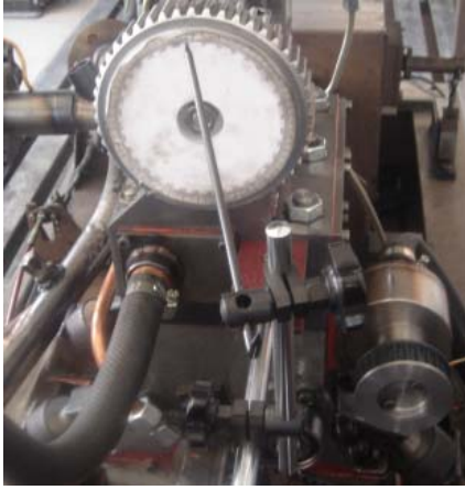
Resim 8.7. Supap zamanlama diyagramına gre kam pozisyon aısının ayarlanması
