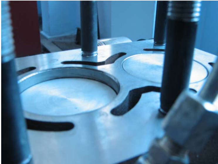
Resim 3.1. İmalatı yapılan motorda pistonların ÜÖN yakınlarındaki konumları
