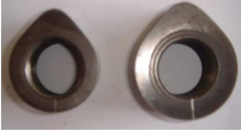
Resim 6.5. Tel erozyonda kesilen 2,094 radyan ( 120^\circ ) supap açık kalma süresine sahip emme ve egzoz kam profilleri
