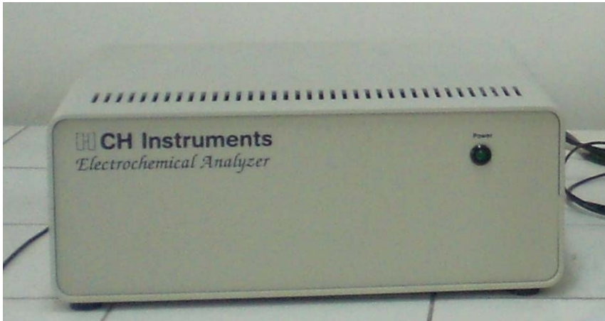
Resim 7. 1. Bilgisayar kontrollü CH Instruments 660 B model potansiyotat
