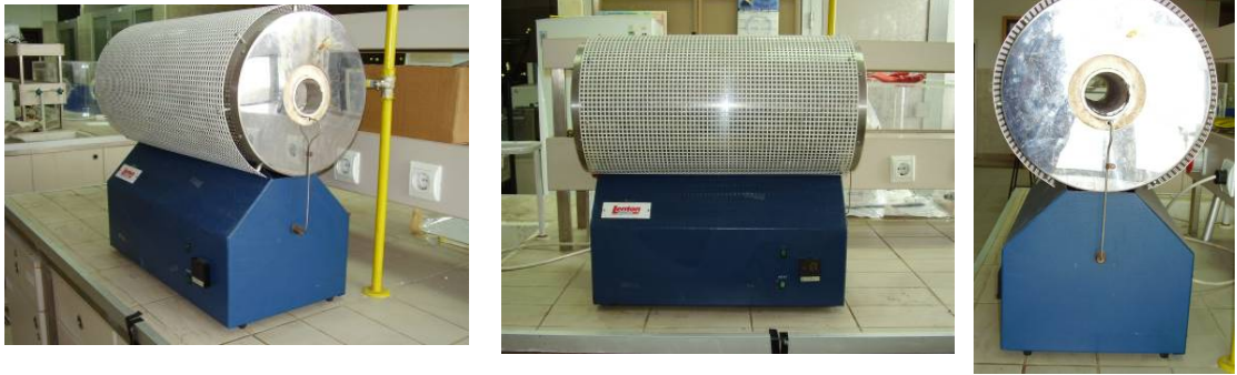
Resim 7. 5. İnert argon atmosferinde sinterleme işleminin yapıldığı yatay tüp fırın
