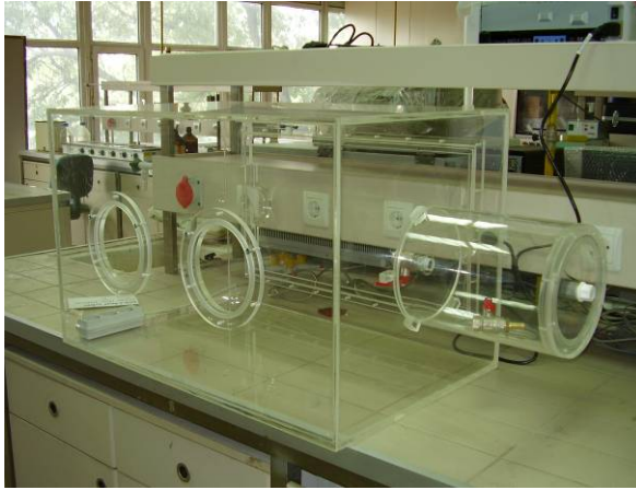
Resim 7. 6. İnert ortamda numune hazırlayabilmek için pleksi-glastan imal edilen düzenek
