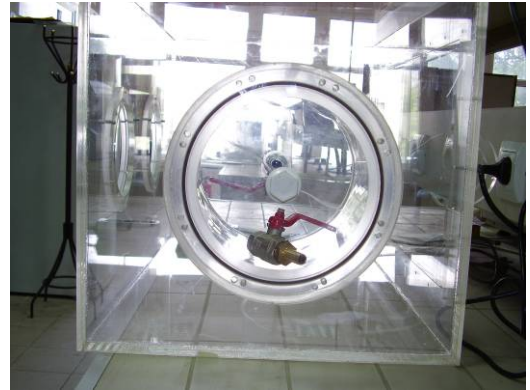
Resim 7. 6. İnert ortamda numune hazırlayabilmek için pleksi-glastan imal edilen düzenek
