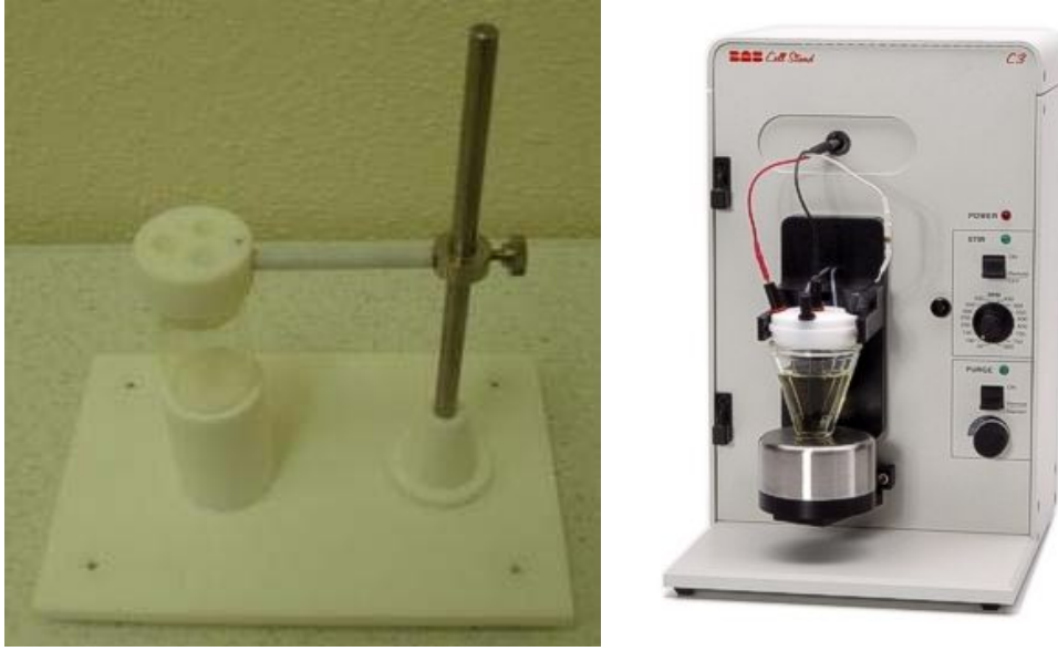
Resim 7. 2. Basit bir hücre düzeneği ve 10 mL'lik BAS C3 tipi hücre
