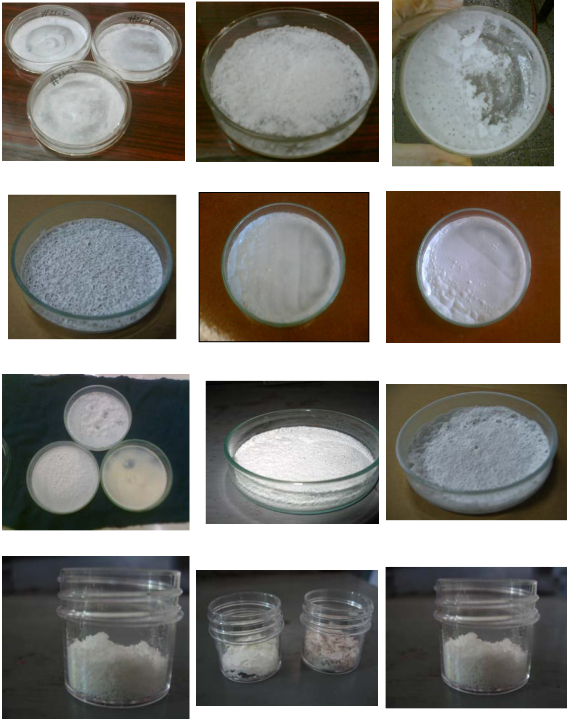
Resim 8. 1. Ekstraksiyon işlemi sonucu elde edilen beyaz renkli, katı \text{NaBH}_4 ürünlerinden bazılarının resimleri
