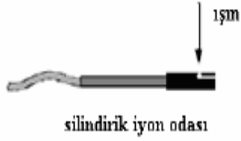
Şekil 3.2. Farmer iyon odasının ölçüm yerleşimi
