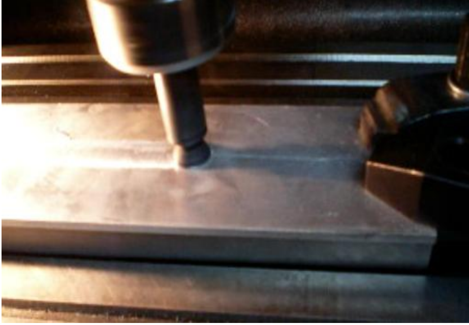
Resim 4.8. Sürtünme karıştırma kaynak yönteminde pimin eğik konumda daldırılması
