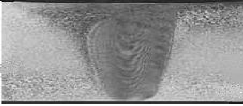
Resim 4.5. Sürtünme karıştırma kaynağı yapılmış Al-alaşımının kaynak bölgesinin kesiti [Ataoğlu, 2002]
