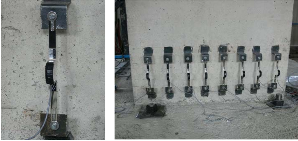
Resim 4.17. Çatlak ölçer düzeneği
