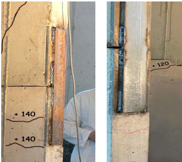
Resim 4.16. 255 kN yük altındaki çelik plakanın görüntüsü
