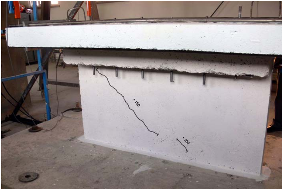
Resim 4.4. 150kN'da oluşan çatlaklar
