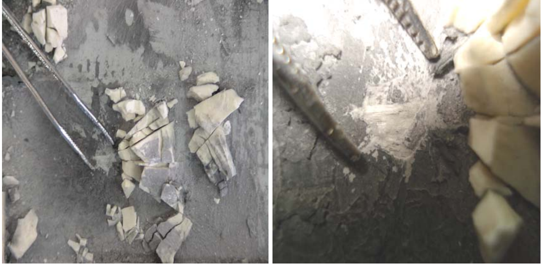
Resim 4.79. Al_2O_3 - kompozit zırh sisteminde ilk atış sonrası hasar yapısı
