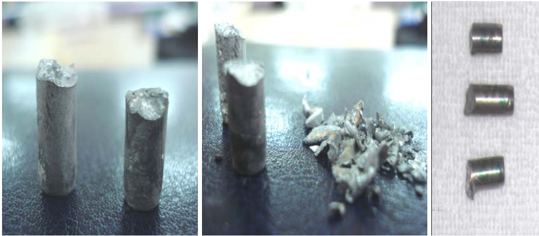
Resim 4.58. Zırh delici merminin seramik tabaka içinde kırılma yapısı
