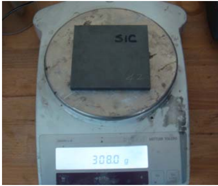
Resim 3.5. Silisyum karbür plakanın ağırlık ölçümü
