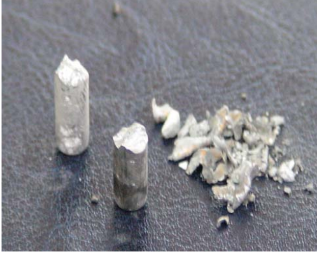
Resim 4.84. Al 2 O 3 - kompozit sistemde balistik darbe sonucu aşınma ve kırılmaya uğrayan sert çelik çekirdekli mermiler
