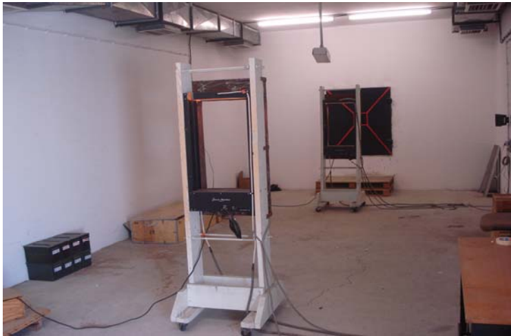
Resim 3.20. Mermi hızını ölçmek için kullanılan perde sistemi
