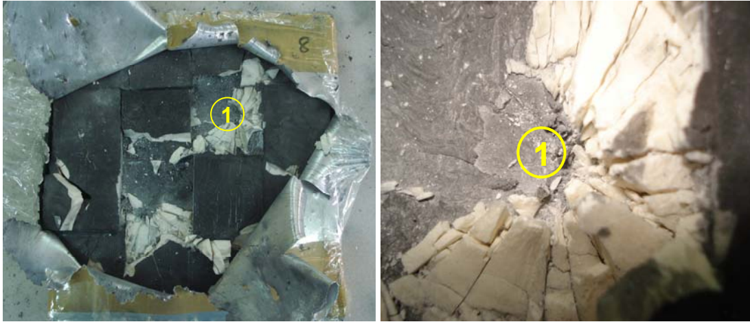
Resim 4.59. Al 2 O 3 - RHA çeliğinde 1 nolu atışta oluşan konik kırılma yapısı
