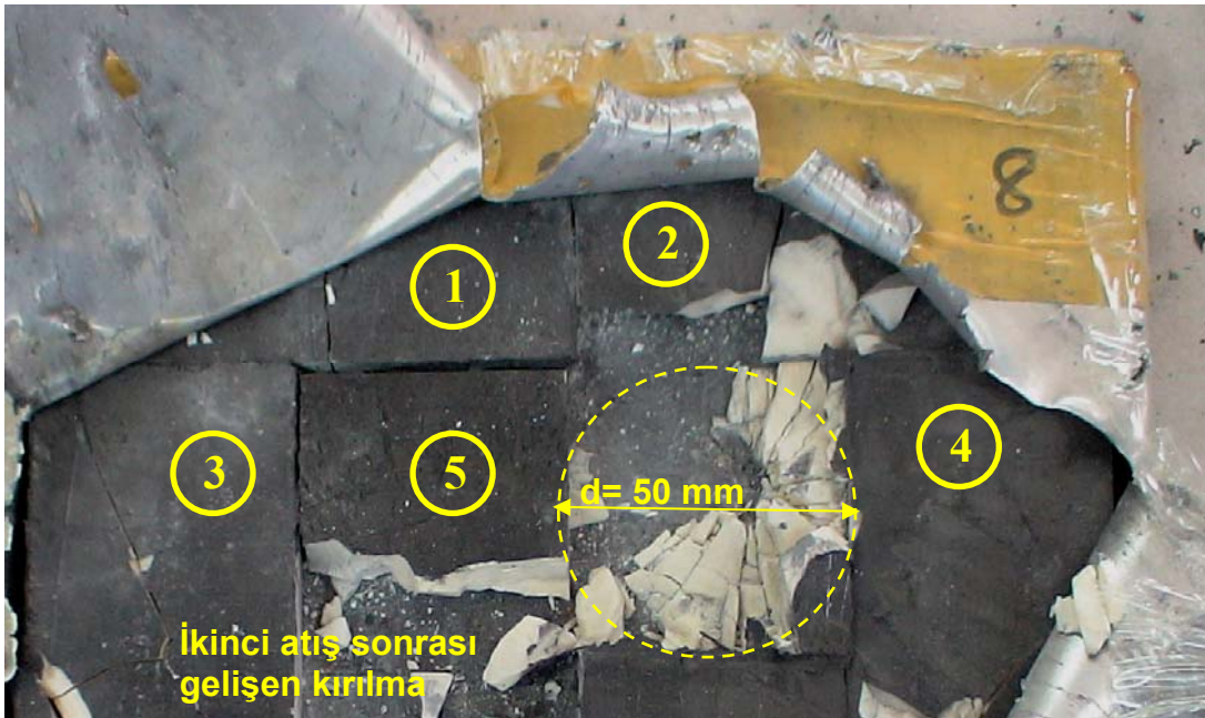
Resim 4.61. Al_2O_3 - RHA çeliği zırh sisteminde alumina plakalarda kırılmalar
