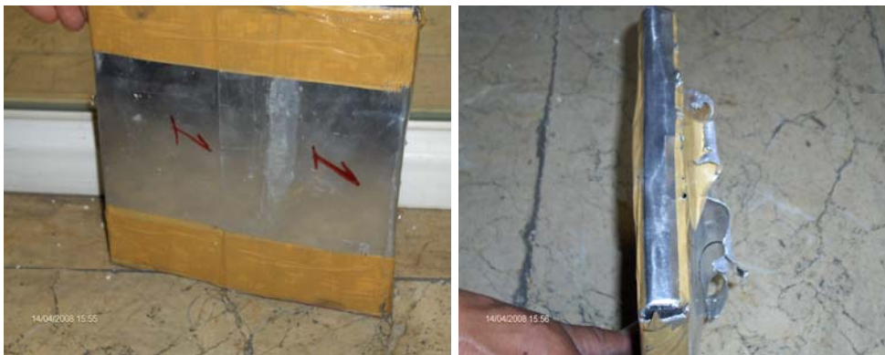
Resim 4.62. Al 2 O 3 - RHA zırh sistemi arka yüzünün atış sonrası fotoğrafları
