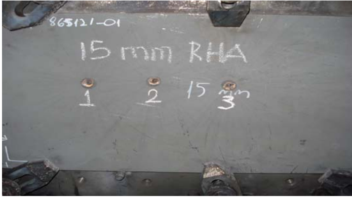
Resim 4.87. 15 mm RHA çeliğinin 7,62 mm AP mermiyle balistik testi
