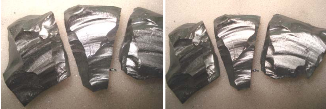
Resim 4.72. B 4 C - kompozit sistemde seramikte gelişen teğetsel kırılmalar
