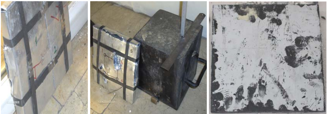
Resim 4.85. Al 2 O 3 - kompozit zırh sisteminin ikinci atış sonrası arka yüzü fotoğrafları ve oluşan çöküntünün ölçülmesi
