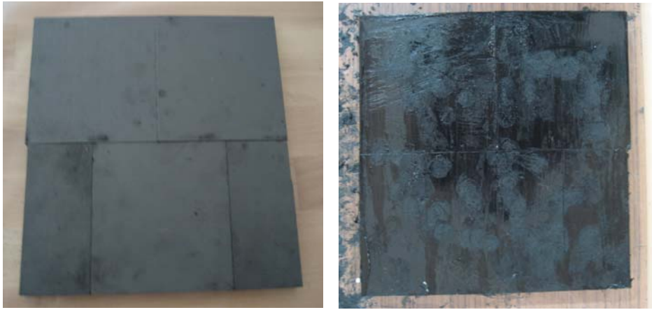
Resim 3.9. Bor karbürlerin polimer yapıştırıcı ile kompozite yapıştırılması
