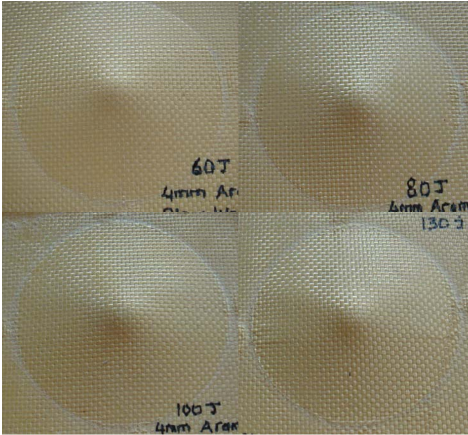
Resim 4.24. 4 mm kalınlığındaki Aramid kompozitin darbe testlerinde arka yüzünde meydana gelen deformasyon fotoğrafları
