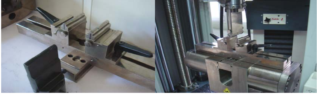
Resim 3.10. Üç noktadan eğme test cihazı, mesnetler ve yük uygulama ucu
