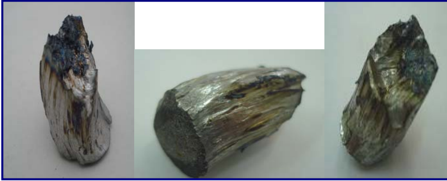
Resim 4.88. Perforasyon neticesinde zırhtan kopan parçalar (plug)
