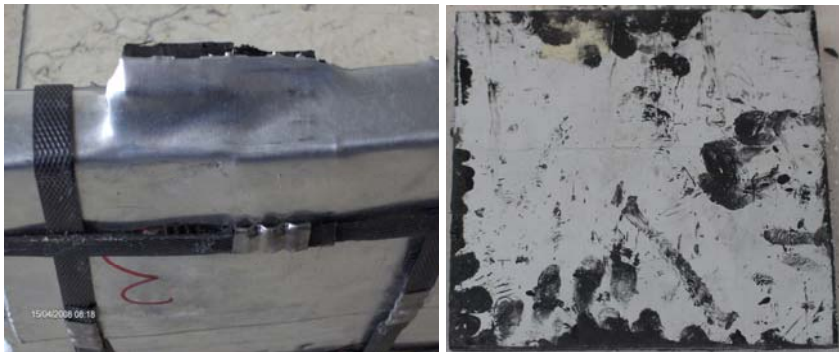
Resim 4.73. B 4 C - kompozit sisteminin ilk atış sonrası arka yüz fotoğrafları
