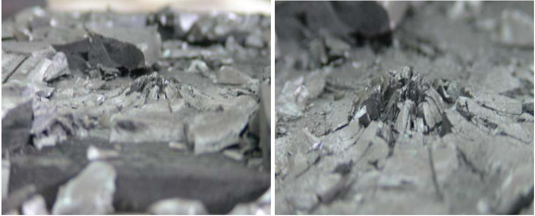
Resim 4.68. B 4 C - RHA sisteminde birinci atışta meydana gelen kırılma krater yapısı
