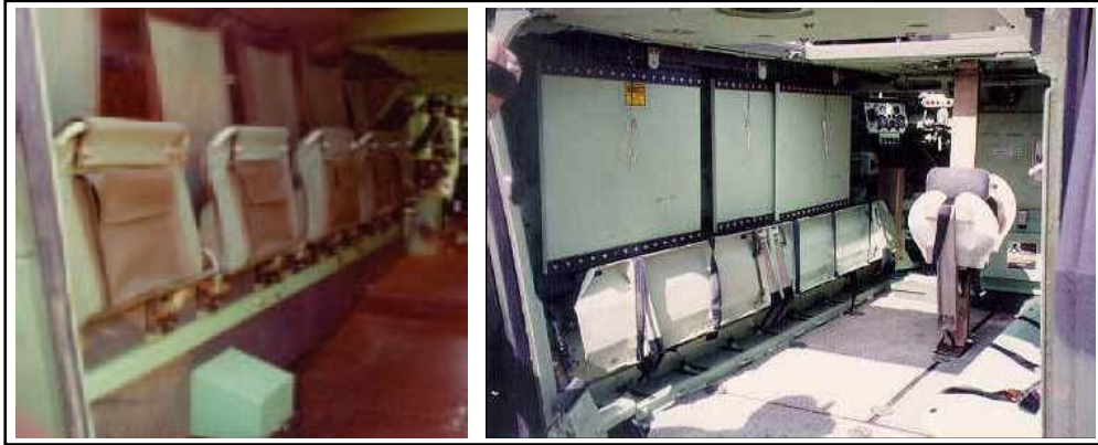
Resim 2.7. Parçacık tutucu kompozit panellerin araç içi uygulaması [58]
