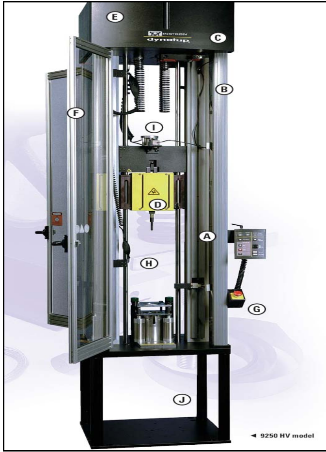
Resim 3.16. Dynatup 9250 test düzeneğinin yapısal bölüm ve elemanları
