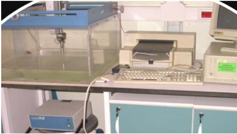
Resim 3.28. Ultrasonik daldırma tekniği - PAC ULTRAPAC-II
