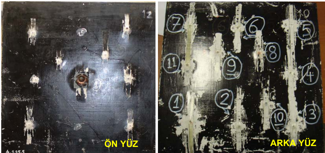
Resim 4.51. 40 mm E-Cam kompozitin balistik testlerine ait ön ve arka yüz fotoğrafları
