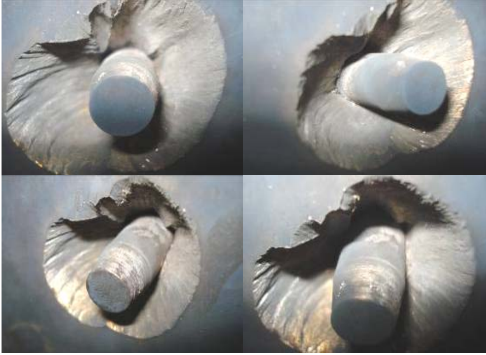
Resim 4.90. RHA çeliğine 14.5 mm RUS B32 mermisi ile yapılan atışa ait fotoğraflar (0° çarpma açısı)
