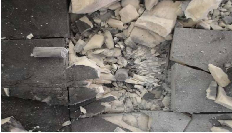
Resim 4.82. Al_2O_3 - kompozit sistemde ikinci atışta meydana gelen kırılmalar
