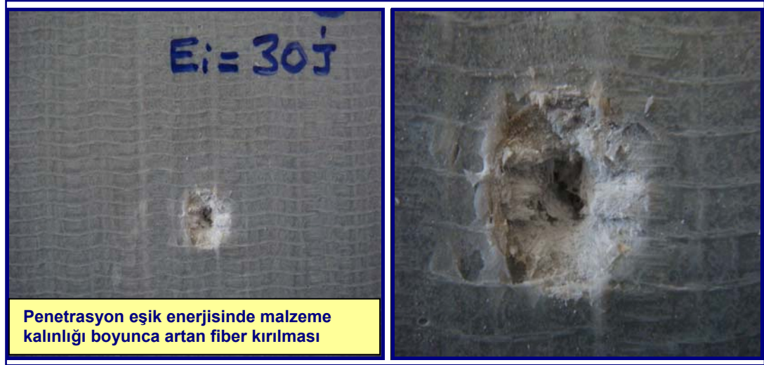
Resim 4.9. 4 mm E-Cam tek yönlü [90/0] 9 Kompozitin 30 J ile darbe testi sonrası ön yüzünde meydana gelen hasar yapısı
