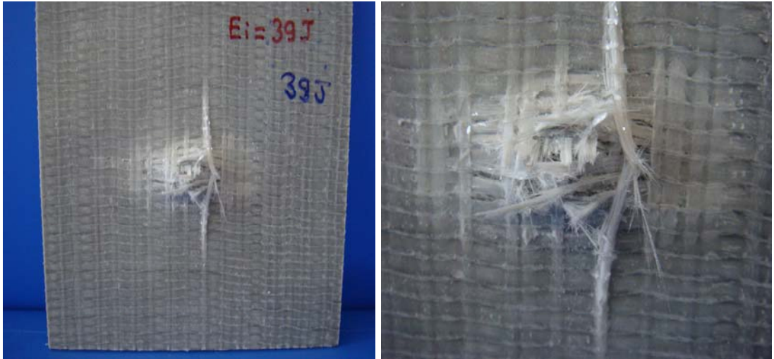
Resim 4.15. 4 mm E-Cam tek yönlü [90/0] 9 kompozitin 39 J ile darbe testi sonrası arka yüzünde oluşan perforasyon hasarı
