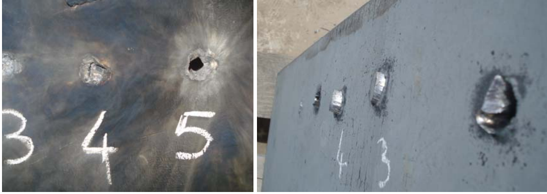
Resim 4.89. RHA çeliğinin ön yüzünde kısmi penetrasyon neticesinde kalınlık boyunca kayarak arka yüzde çıkıntı oluşturan parça
