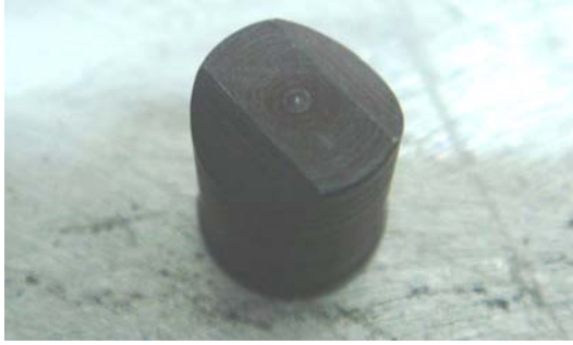
Resim 4.53. STANAG 2920'ye uygun 0,30 kalibre, 2,851 g FSP mermi
