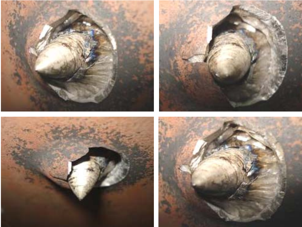
Resim 4.91. RHA çeliğine 14.5 mm RUS B32 mermisi ile yapılan atışın hedef arkası fotoğrafları (0° çarpma açısı)
