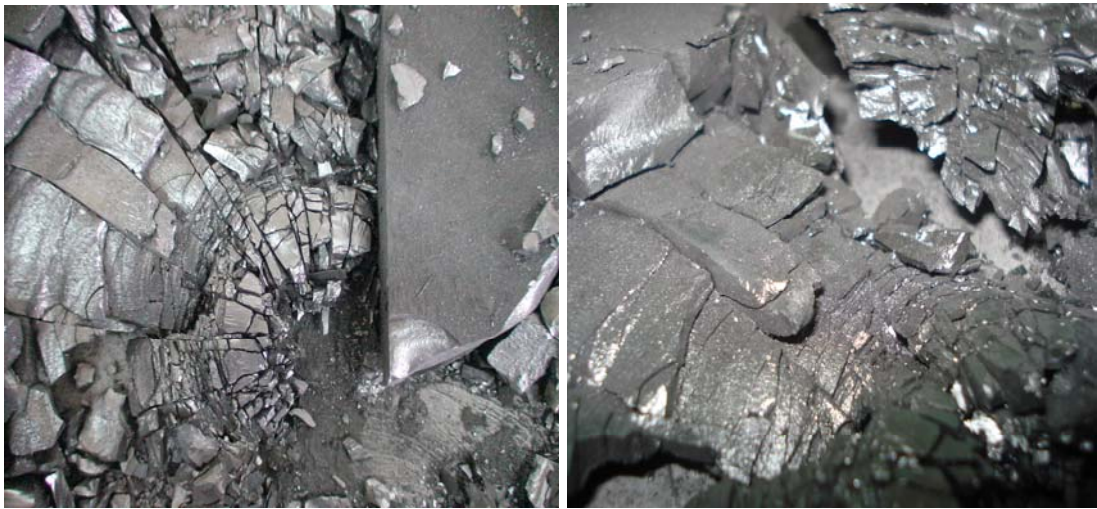
Resim 4.71. B 4 C - kompozit sistemin ilk atış sonrası kırılma alanı fotoğrafları
