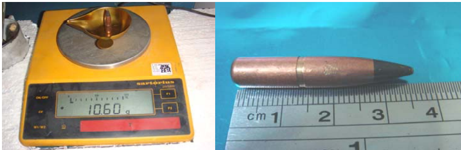
Resim 3.24. A.B.D. yapımı 7,62 x 63 mm AP M2 zırh delici mermi çekirdeğinin ağırlık ve uzunluk ölçümü
