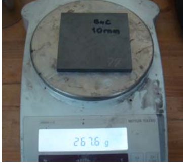
Resim 3.3. Bor karbür plakanın ağırlık ölçümü
