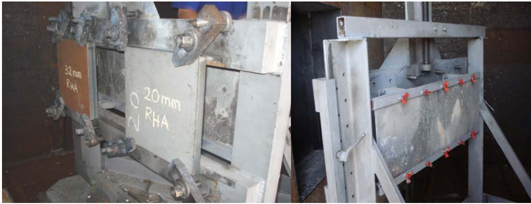
Resim 3.22. Hedef tespit düzeneđi (test numunesi ve řahit plaka bađlantısı)
