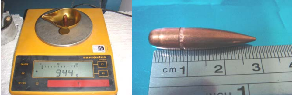
Resim 3.25. MKEK yapımı 7,62 x 51 mm NATO FMJ mermi çekirdeğinin ağırlık ve uzunluk ölçümü
