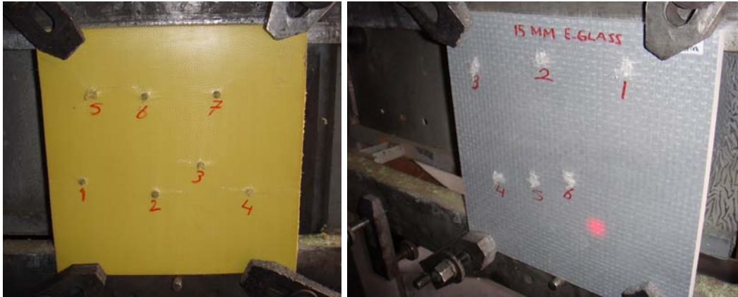
Resim 4.54. 7,5 mm Aramid ve 15 mm E-Cam kompozitin 0,30 kalibre FSP mermi ile V_{50} balistik hız limitlerinin bulunması
