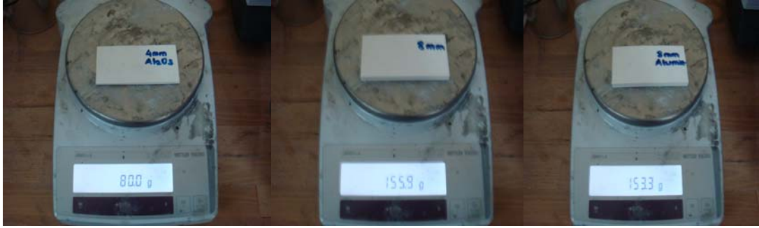
Resim 3.2. Alumina plakaların ağırlıklarının ölçümü
