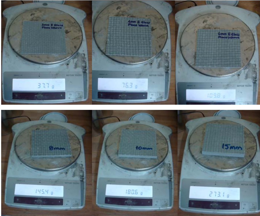
Resim 3.8. Dokuma E-Cam kompozit plakaların ağırlık ölçümü
