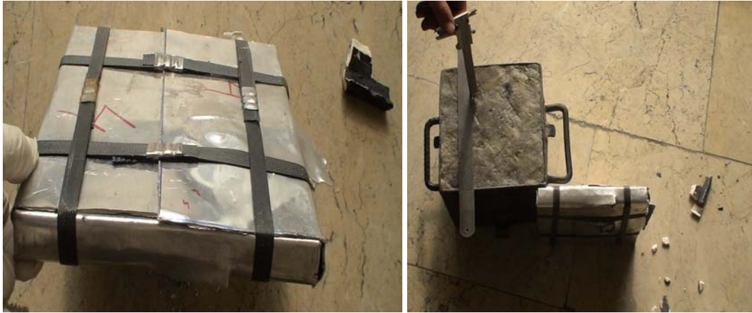
Resim 4.80. Al_2O_3 - kompozit zırh sisteminin birinci atış sonrası arka yüzü fotoğrafları ve oluşan çöküntünün ölçülmesi
