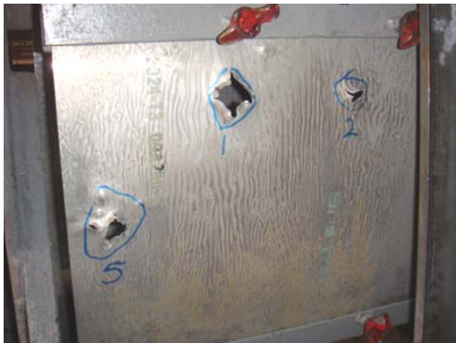
Resim 4.43. 7,62 mm NATO FMJ mermi ile 10 mm kalınlıktaki E-Cam kompozitin balistik testlerinde hedef arkası şahit plaka
