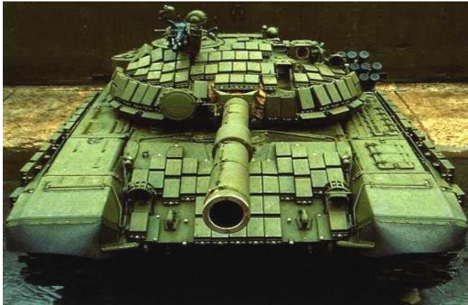
Resim 2.1. Reaktif zırh modüllerinin pasif zırh üzerine monte edilmesi [1]
