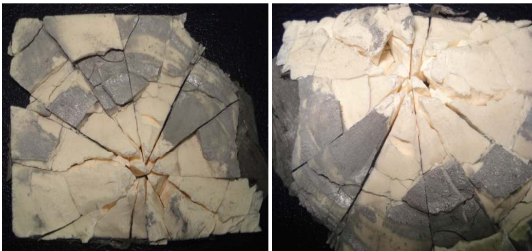
Resim 4.60. Al 2 O 3 -Alüminyum T2024 zırh sisteminde oluşan kırılma yapısı
